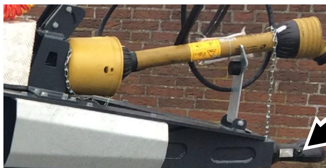
Obrázek 30: Spojovací body – typ K80 EAD 14
