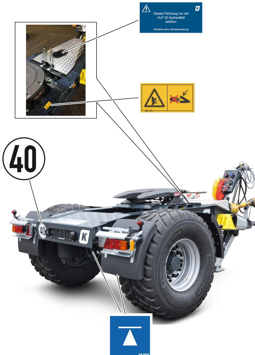
Obrázek 3: Bezpečnostní štítky a štítky s upozorněním na boku podvozku, zde: EAD 14 levá strana
