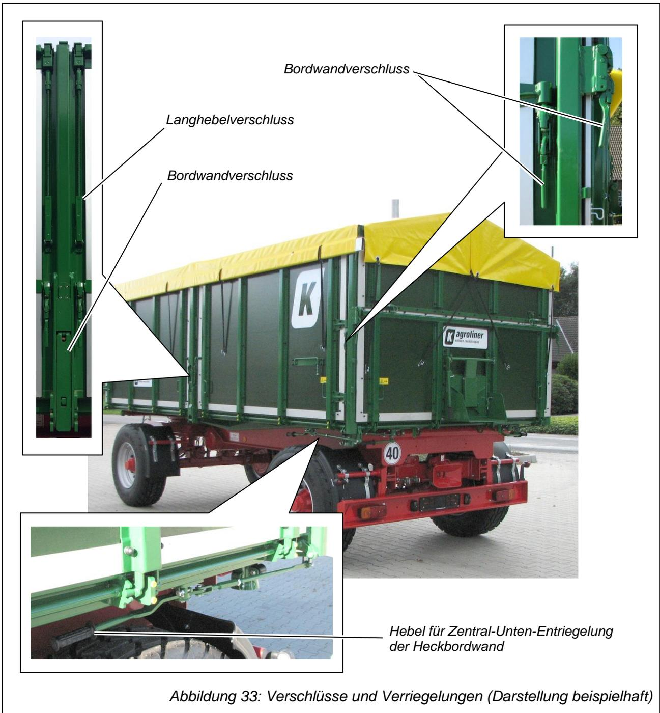
Abbildung 33: Verschlüsse und Verriegelungen (Darstellung beispielhaft)
