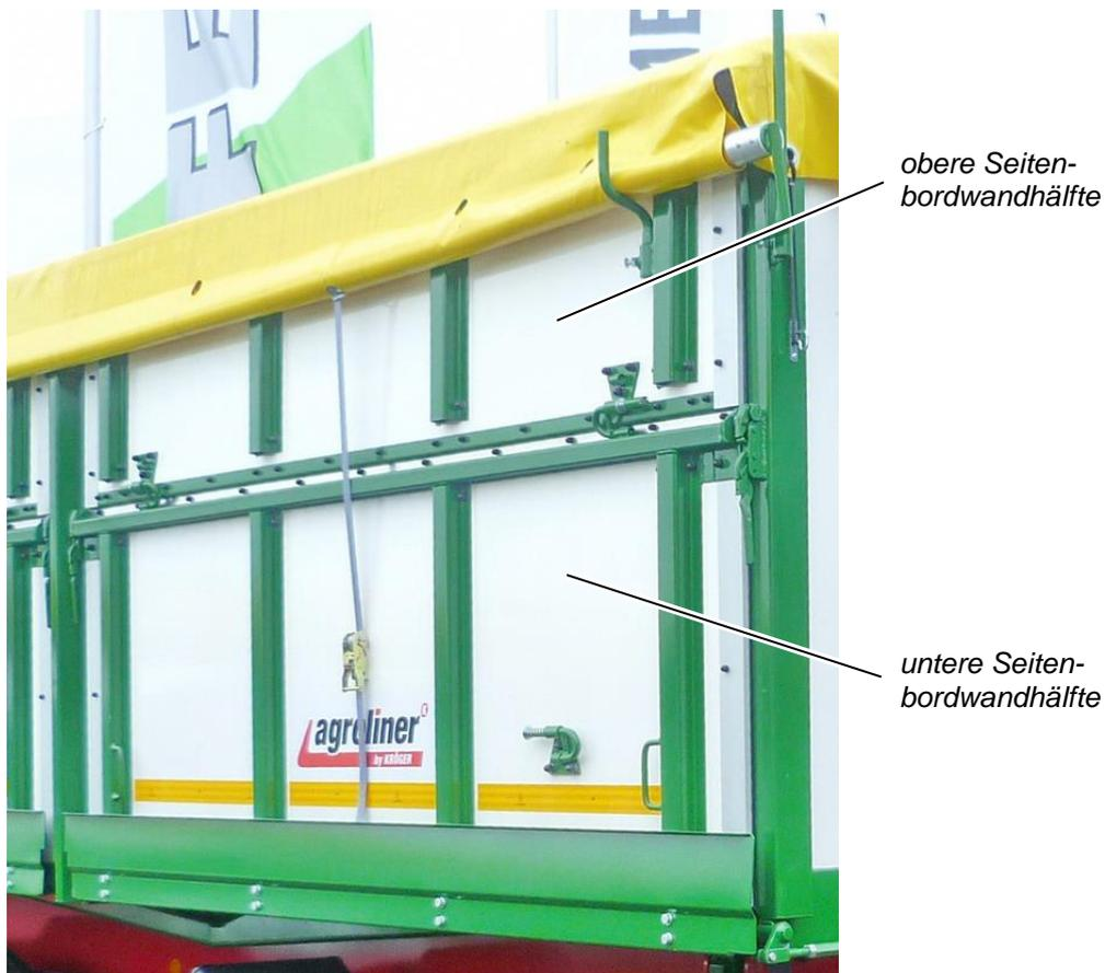
Abbildung 42: Horizontal geteilte Seitenbordwand, hier: TKD 302, vorne rechts, mit Kunststoffwänden (Option)
