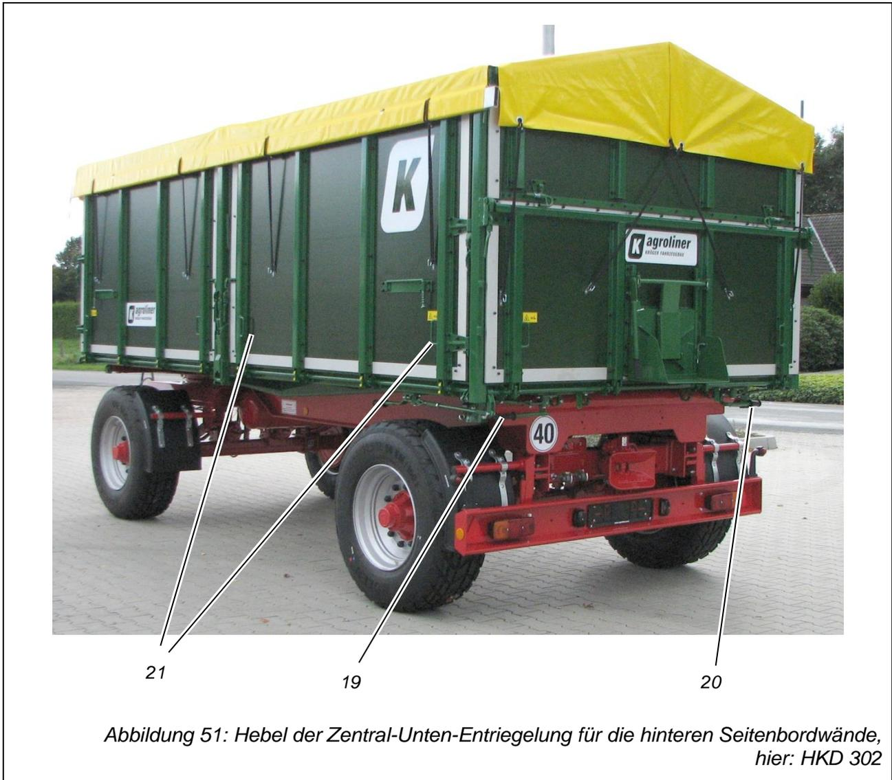
Abbildung 51: Hebel der Zentral-Unten-Entriegelung für die hinteren Seitenbordwände, hier: HKD 302
