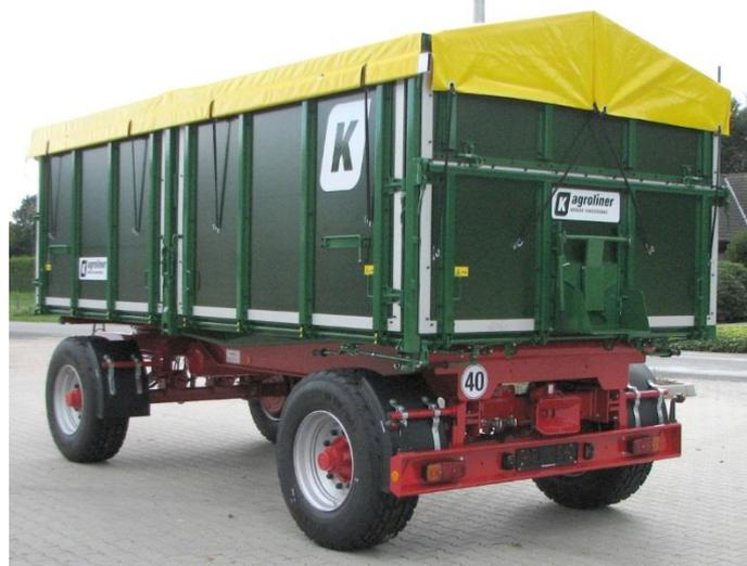
Abbildung 74: Rollplane korrekt verschlossen
