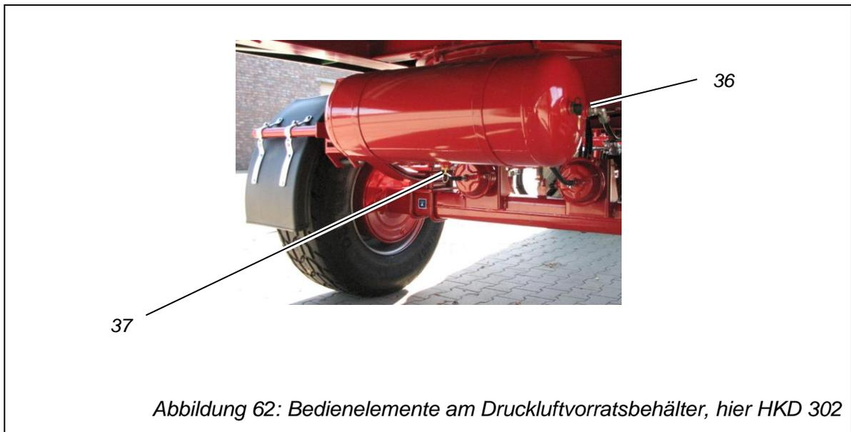
Abbildung 62: Bedienelemente am Druckluftvorratsbehälter, hier HKD 302
