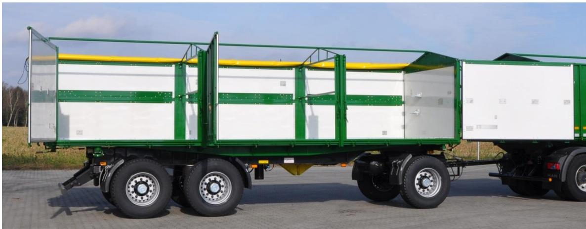
Abbildung 31: Seitenbordwände mit Portalfunktion (Option), hier: HKD 402
