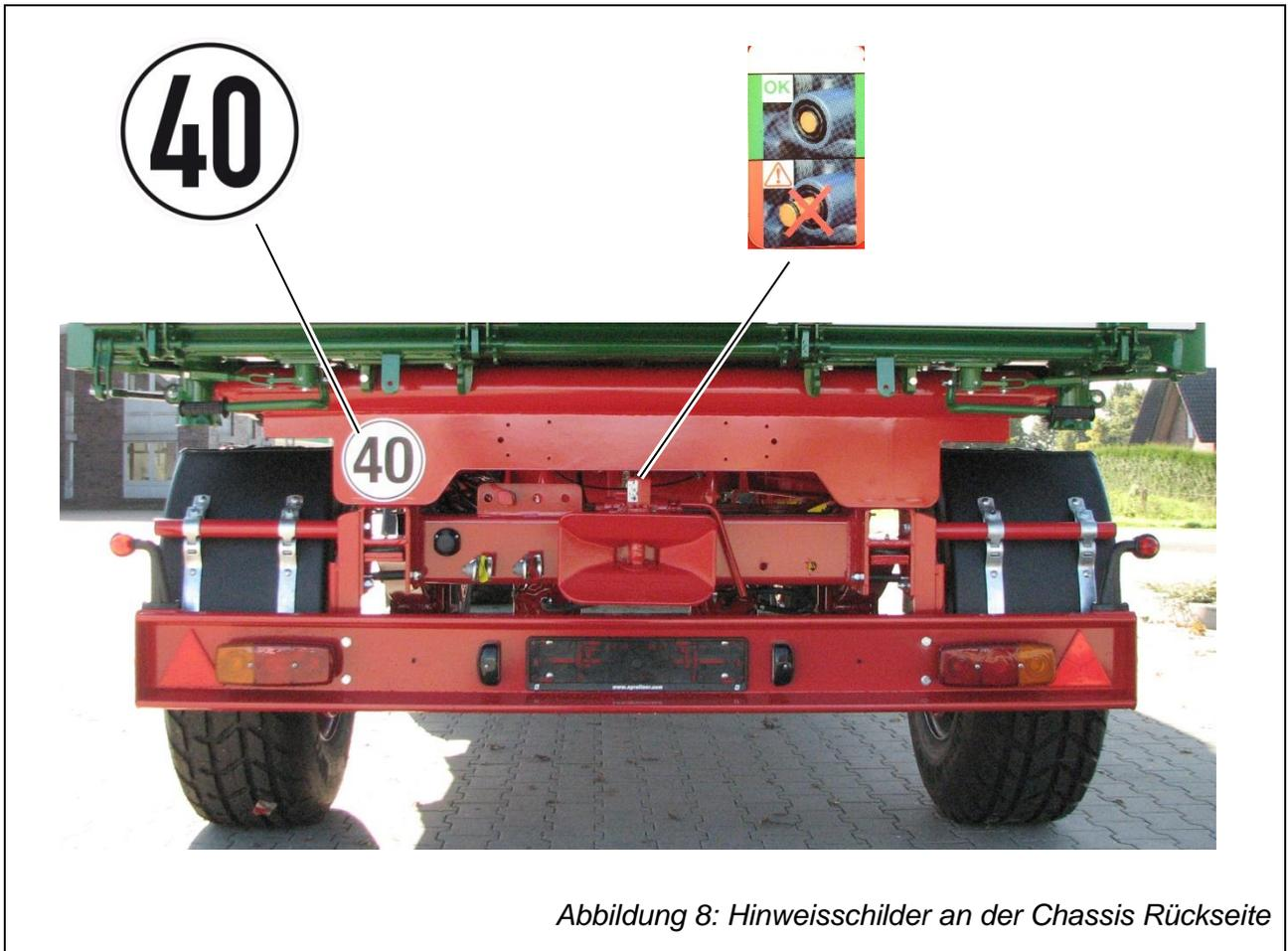
Abbildung 8: Hinweisschilder an der Chassis Rückseite
