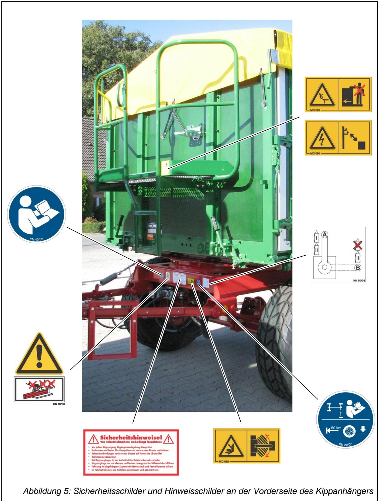
Abbildung 5: Sicherheitsschilder und Hinweisschilder an der Vorderseite des Kippanhängers
