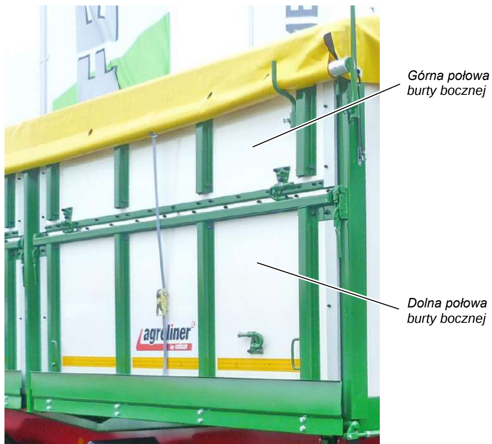
Ilustracja 42: Burta boczna dzielona w poziomie, tutaj: TKD 302, z przodu z prawej strony, ze ścianami z tworzywa sztucznego (opcja)
