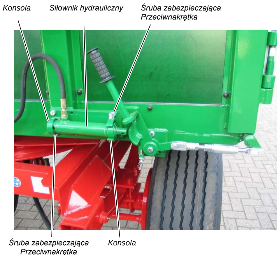
Ilustracja 70: Przekładanie siłownika hydraulicznego mechanizmu zdalnego odblokowywania burt (opcja)
