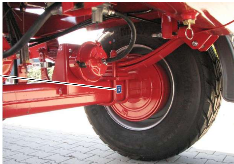
Ilustracja 7: Oznaczenie punktów podparcia dźwignika samochodowego, tutaj: z przodu po prawej stronie
