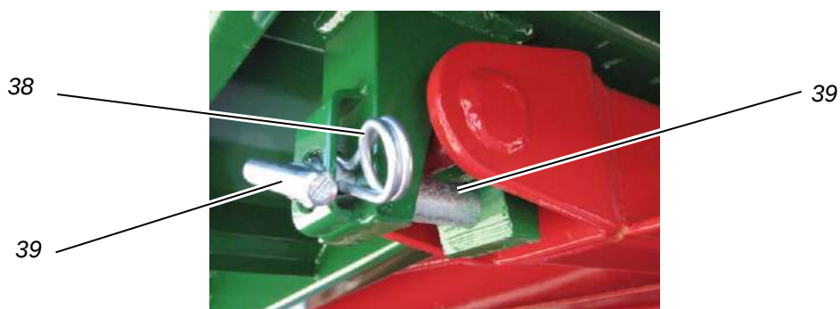
Ilustracja 64: Łożysko wywrotu, tutaj: HKD 302 z tyłu z lewej strony
