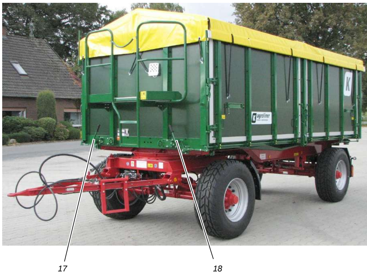
Ilustracja 50: Dźwignie dolnej centralnej blokady przednich burt bocznych, tutaj: HKD 302
