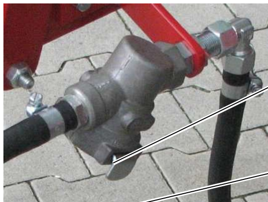
Ilustracja 92: Filtr przewodu zasilającego, tutaj: HKD 302
