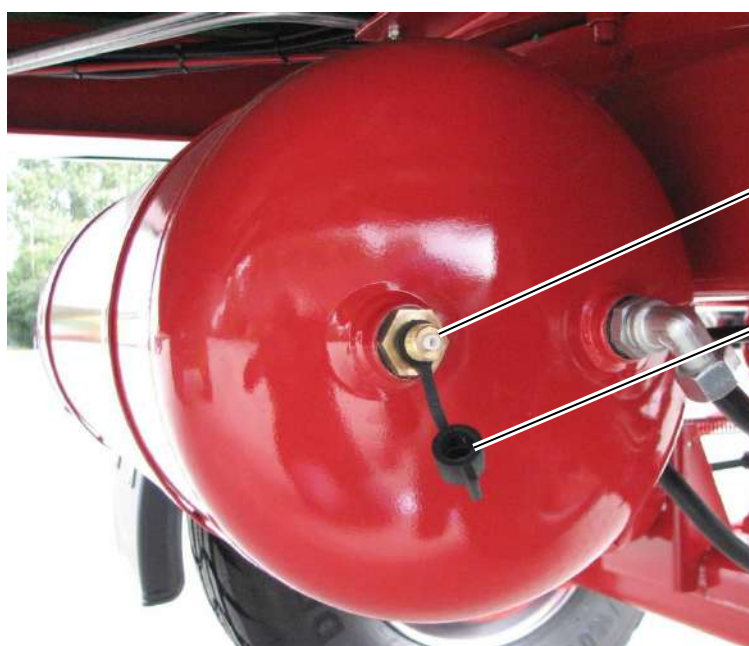
Ilustracja 88: Przyłączy kontrolne na manometr na zasobniku sprężonego powietrza
