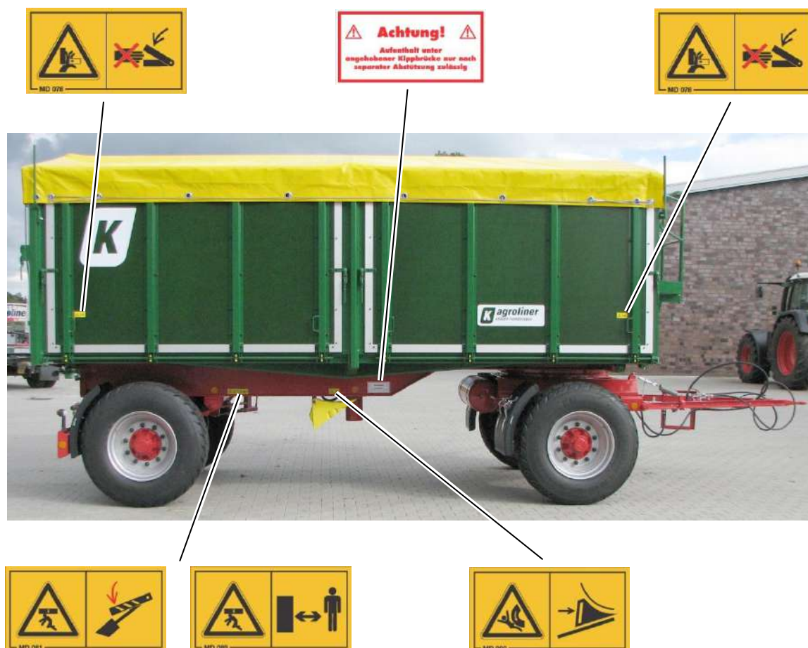
Ilustracja 6: Tabliczki ostrzegawcze i informacyjne z boku przyczepy wywrotki
