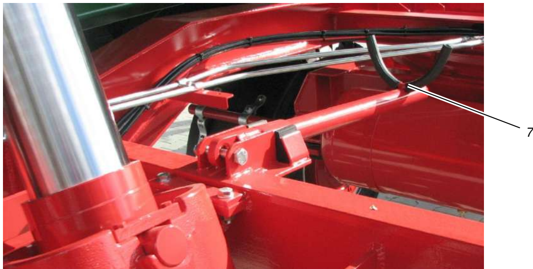
Ilustracja 47: Podpora mechaniczna, tutaj: HKD 302
