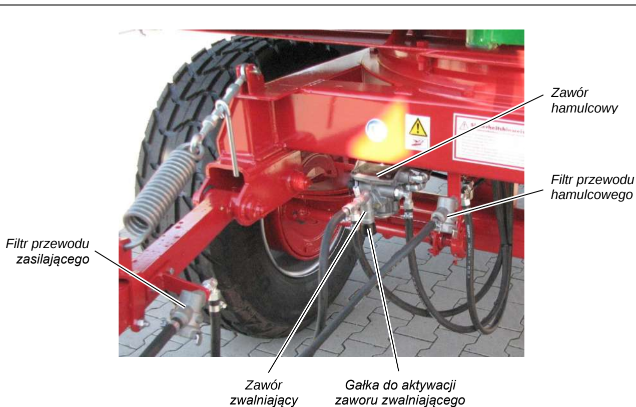
Ilustracja 22: Zawory i filtr hamulca roboczego, tutaj: HKD 302
