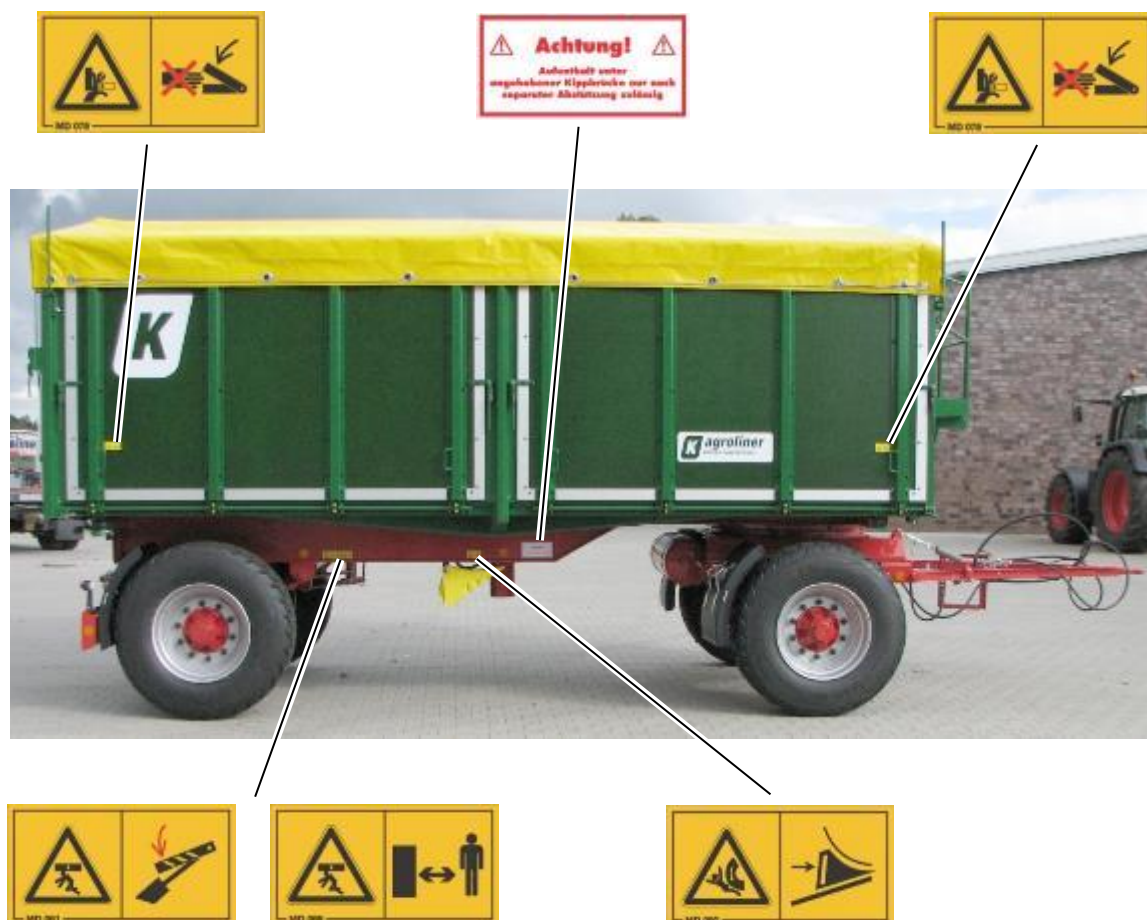
6. ábra: Biztonsági és információs jelzések a billenő pótkocsi oldalán
