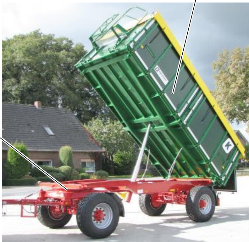
15. ábra: Billenő pótkocsi fő részegységei, itt: HKD 302
