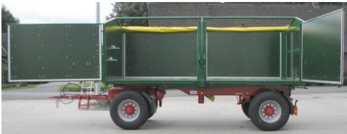
30. ábra: Bukóoldalak portálfunkcióval (opcionális), itt: HKD 302
