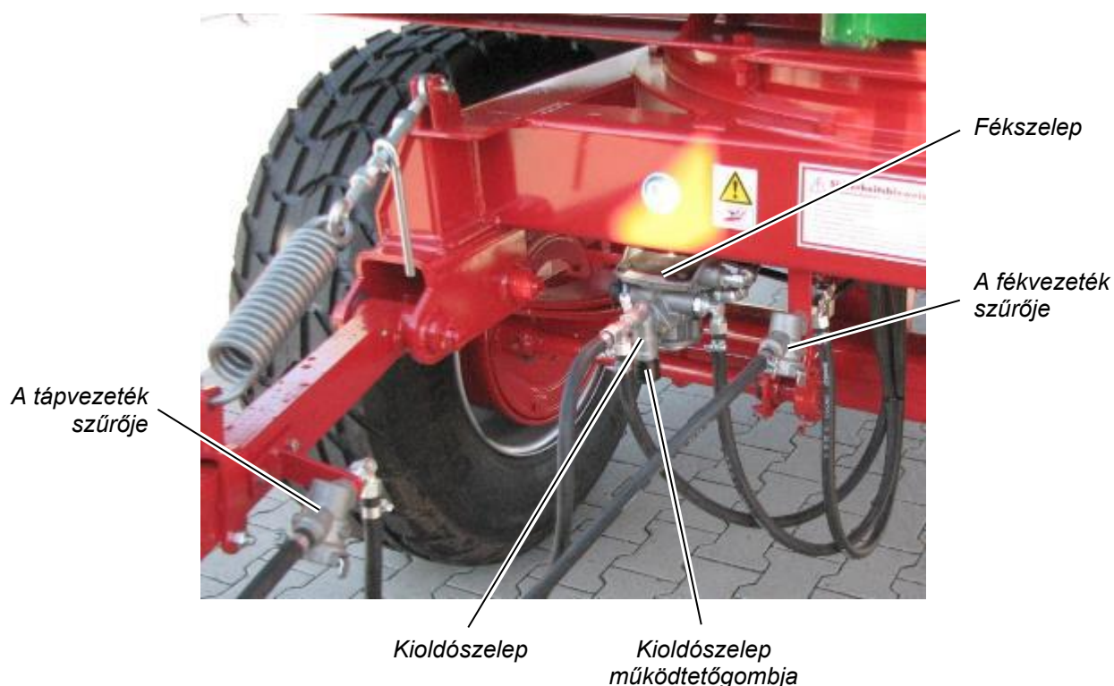
22. ábra: Üzemi fék szelepei és szűrői, itt: HKD 302
