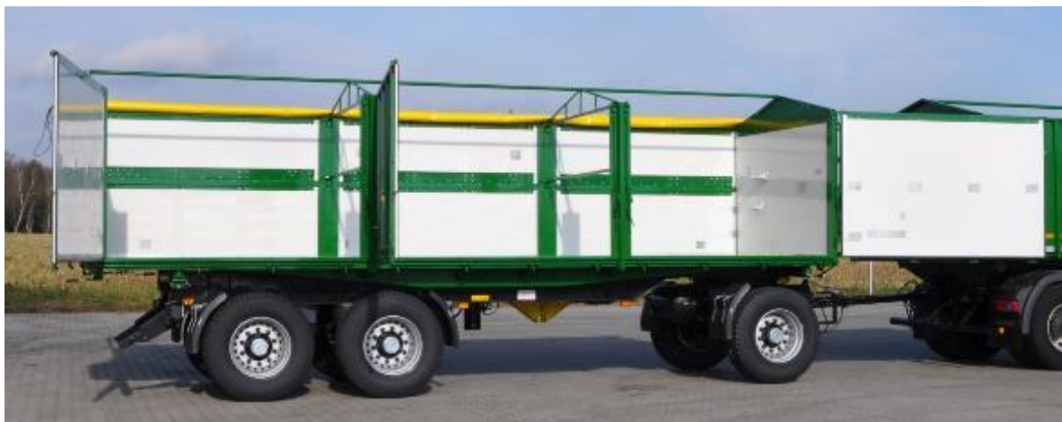
31. ábra: Bukóoldalak portálfunkcióval (opcionális), itt: HKD 402
