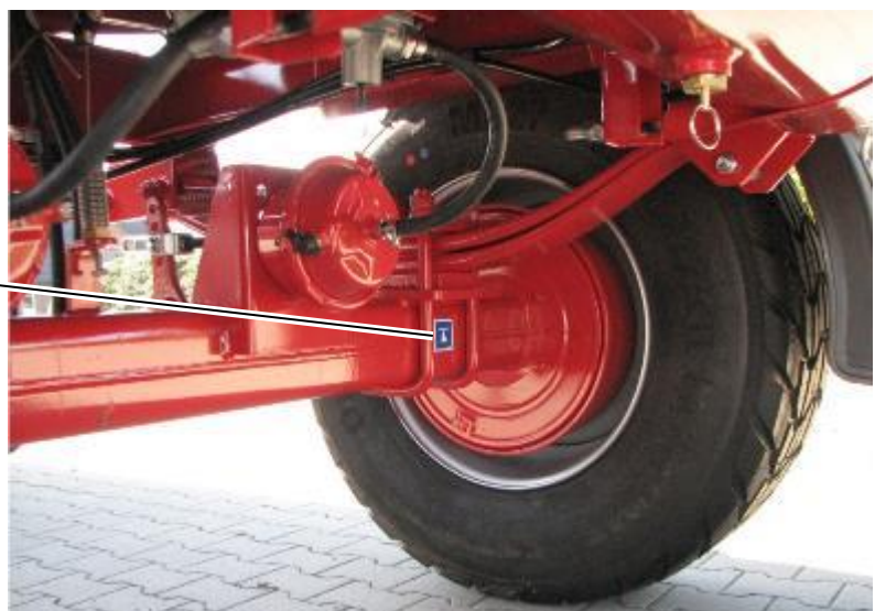
7. ábra: Az emelők rögzítési pontjainak jelölése, itt: elől jobbra
