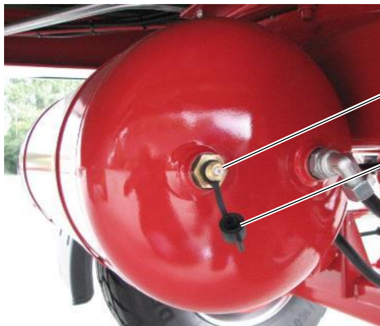
89. ábra: Tesztcsatlakozó a sűrítettlevegő-tartály nyomásmérőjéhez
