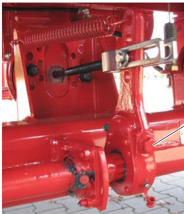
92. ábra: Fékhenger lökete, itt: HKD 302 - jobb első fékhenger
