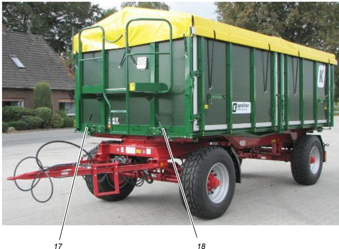
50. ábra: Az első bukóoldalak központi alsó kinyitójának kioldókarja, itt: HKD 302
