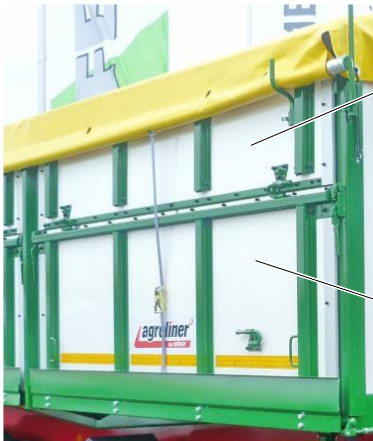
42. ábra: Vízszintesen osztott bukóoldal , itt: TKD 302, jobb első, műanyag bukóoldalakkal (opcionális)
