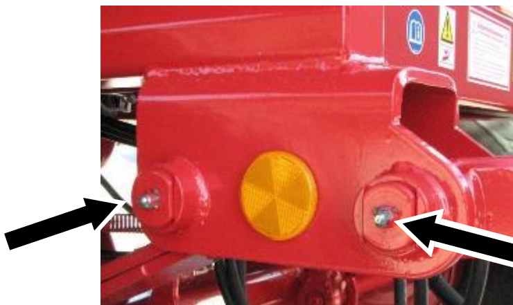
83. ábra: Csuklós vonórúd kenése (csak HKD 302 / HKD 402 esetében), itt: jobb első
