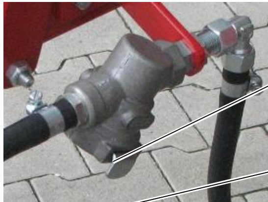
93. ábra: Tápvezeték vezetékszűrője, itt: HKD 302
