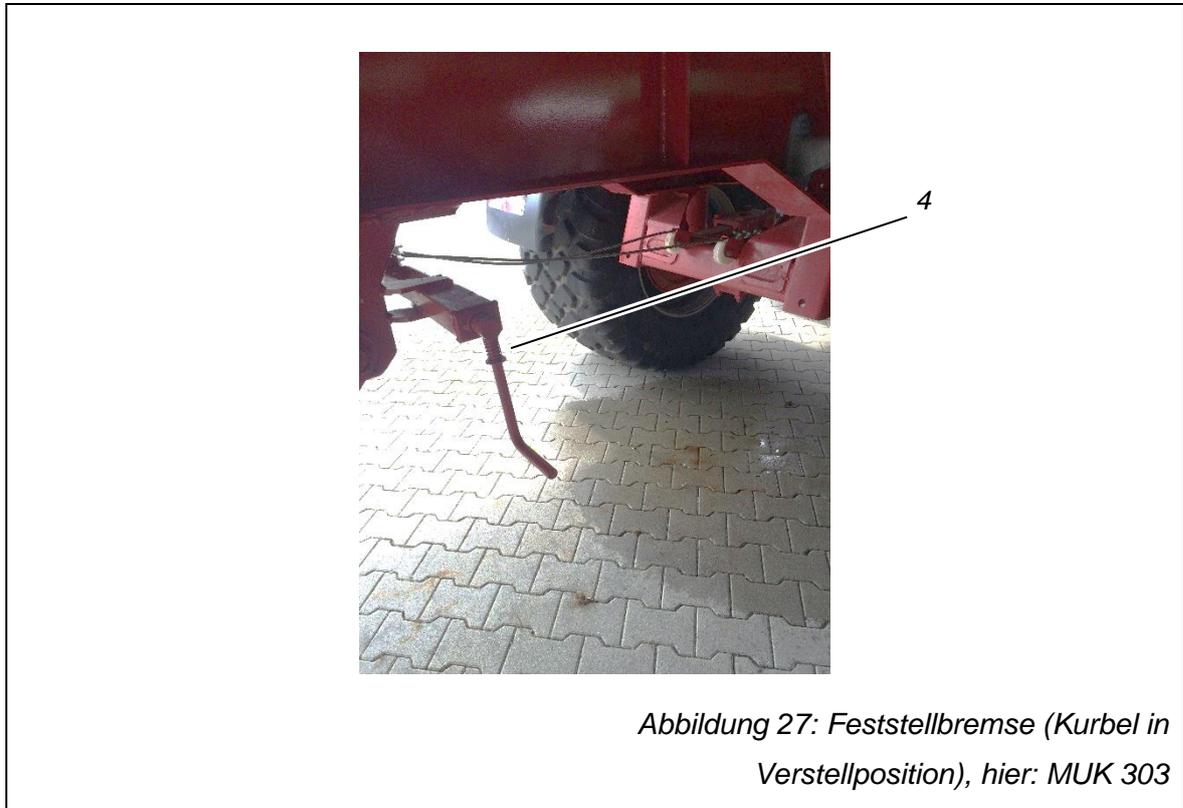
Abbildung 27: Feststellbremse (Kurbel in Verstellposition), hier: MUK 303
