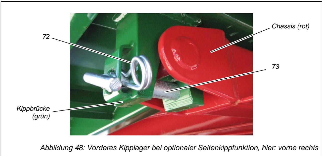
Abbildung 48: Vorderes Kiplager bei optionaler Seitenkippfunktion, hier: vorne rechts
