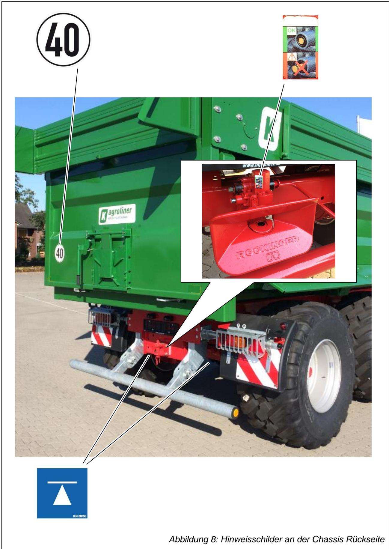
Abbildung 8: Hinweisschilder an der Chassis Rückseite
