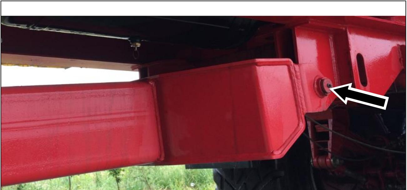
Abbildung 52: Schmiernippel an Zugeinrichtung
