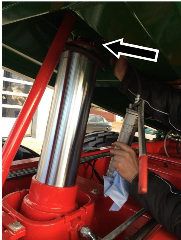
*Abbildung 55: Kipplager und Kippzylinder*
