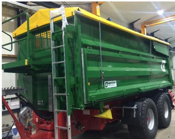
Abbildung 43: Rollplane korrekt verschlossen
