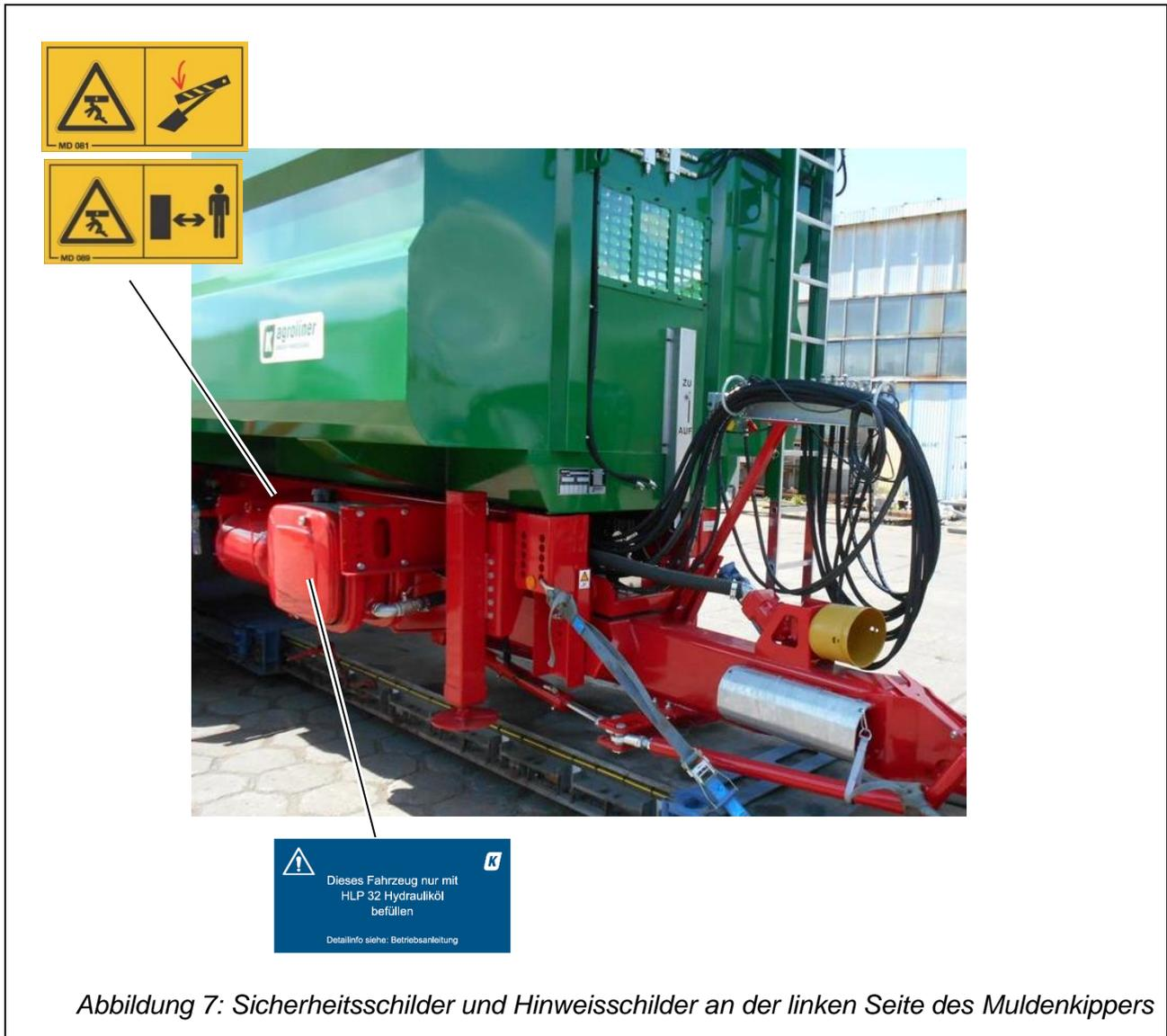
Abbildung 7: Sicherheitsschilder und Hinweisschilder an der linken Seite des Muldenkippers
