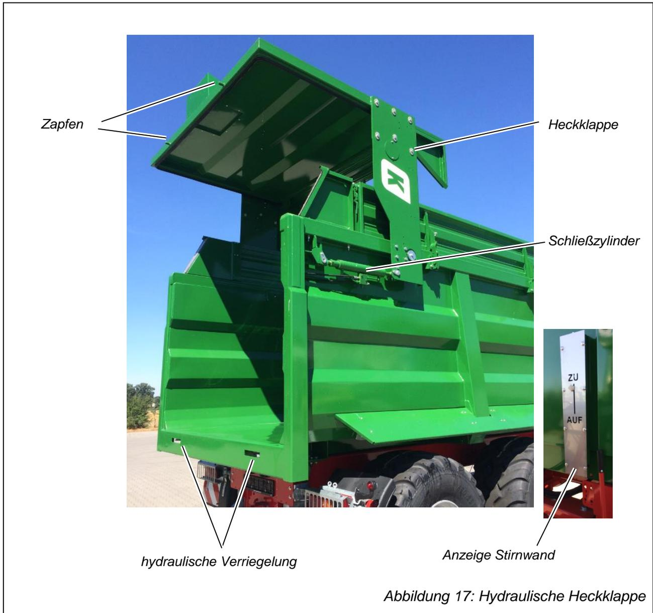
Verriegelt wird die Heckklappe über eine hydraulische Druck-Folge-Schaltung. Sie besteht aus zwei Verriegelungshaken, die um zwei Verriegelungsdorne greifen. Der Zustand der Heckklappenverriegelung wird an der Stirnseite angezeigt. (siehe hierzu: Abbildung 18: Hydraulischer Schaltplan, Basisausstattung und 5.3.28 Verriegelung einstellen)
