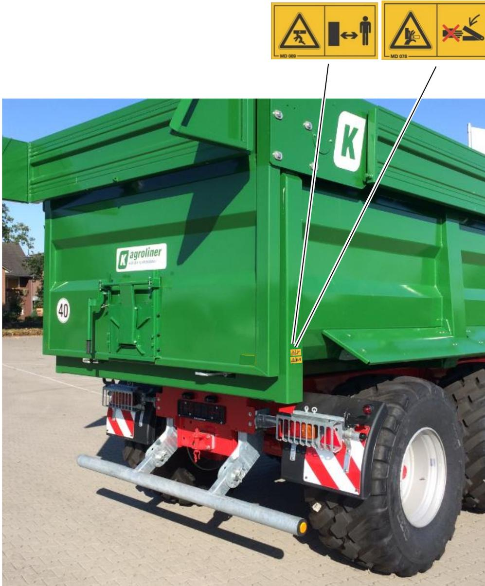
Abbildung 6: Sicherheitsschilder hinten am Muldenkippanhänger
