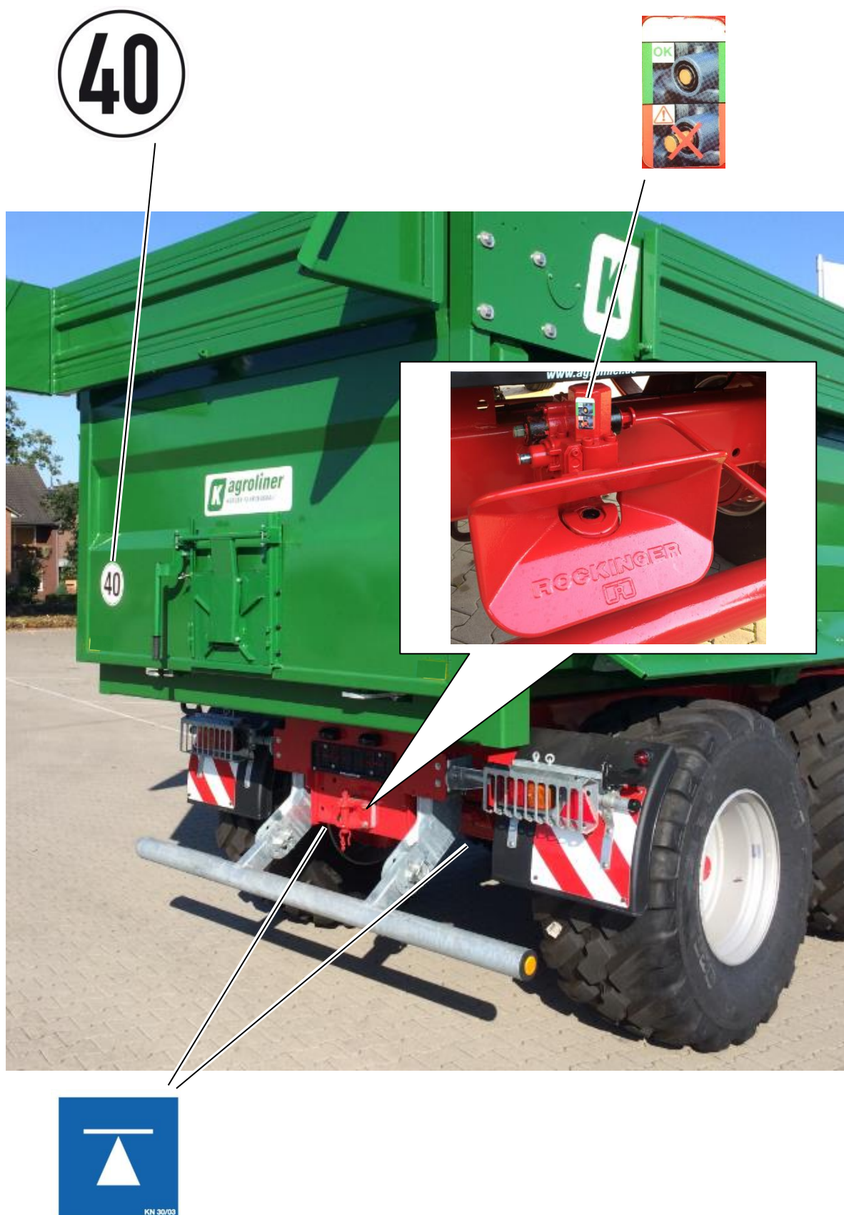
8. ábra: Tájékoztató jelzések az alváz hátoldalán
