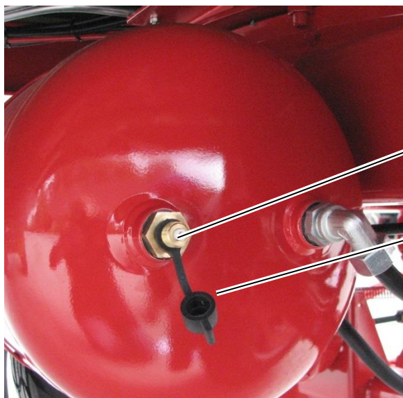
60. ábra: Tesztcsatlakozó a sűrítettlevegő-tartály nyomásmérőjéhez
