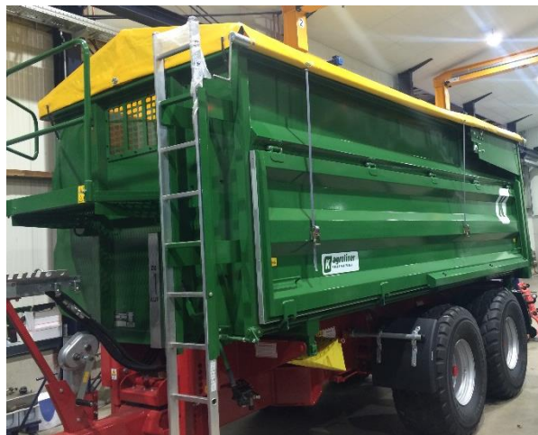
44. ábra: A feltekerhető ponyva megfelelően zárva
