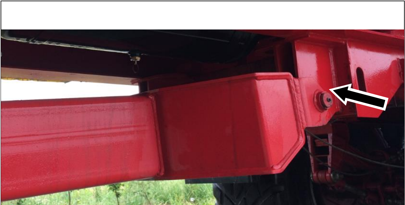
53. ábra: Zsírzógomb a vonószerkezeten (balról és jobbról)
