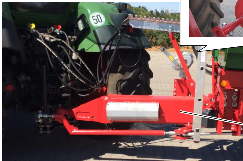
3. ábra: Billenőhidraulika blokkszelepe (A felső képen az alapfelszereltség látható, az alsó képen pedig a „két hidraulikus támasztóláb” és a „kényszerkormányzás” opciók szerepelnek)
