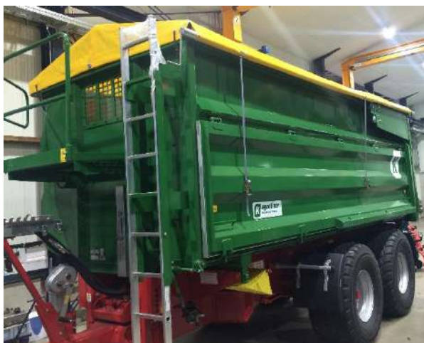
Ilustracja 44: Poprawnie zamknięta plandeka rolowana
