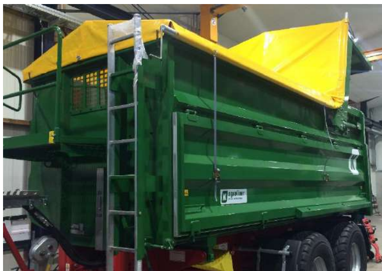
Ilustracja 45: Plandeka rolowana zabezpieczona po zamknięciu
