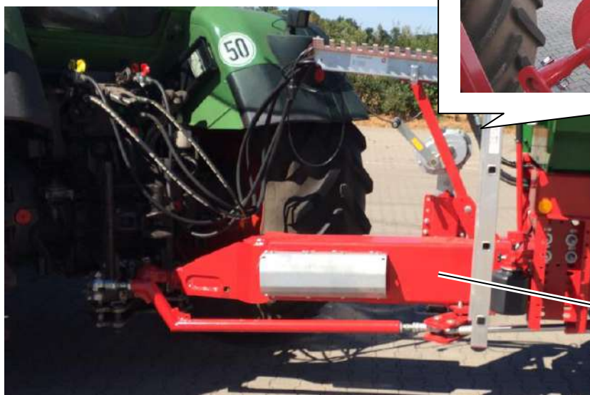
Ilustracja 3: Zawór blokujący hydrauliki wywrotu (zdjęcie na górze z wyposażeniem podstawowym, zdjęcie na dole z opcjami „dwie podpory hydrauliczne” i „układ kierowania wymuszonego”)
