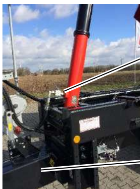
Ilustracja 2: Zawór blokujący hydrauliki wywrotu
