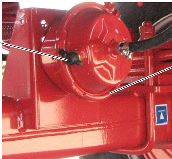
Ilustracja 51: Przyłączy kontrolne do kontroli ciśnienia pompy hamulcowej
