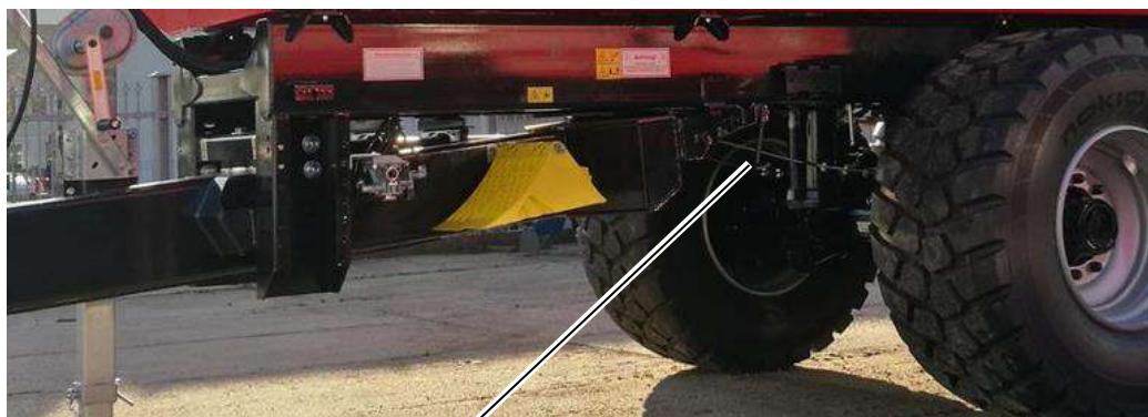
Ilustracja 25: Hamulec postojowy (korba w pozycji regulacji), tutaj: MUP 20 HP
