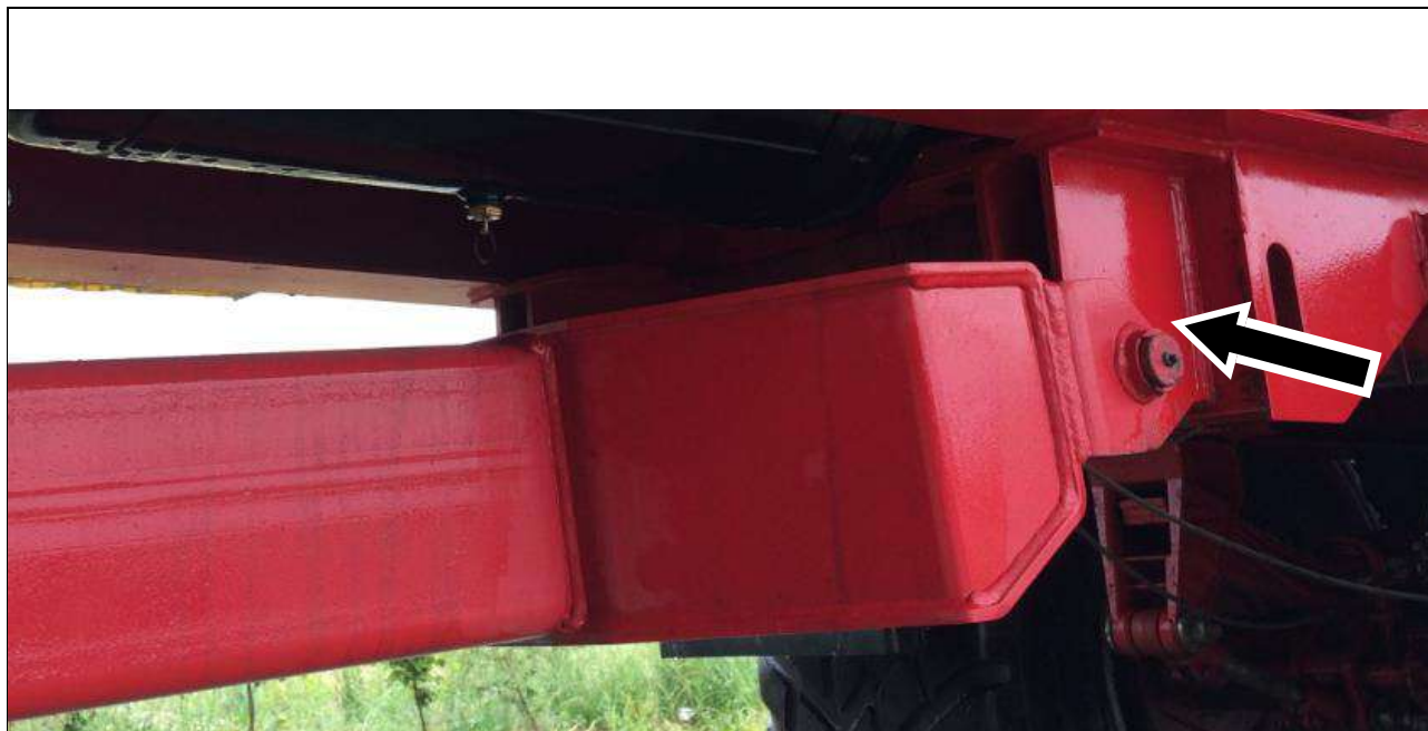
Ilustracja 43: Gniazdo smarowe na zaczepie (strona lewa identyczna z prawą)
