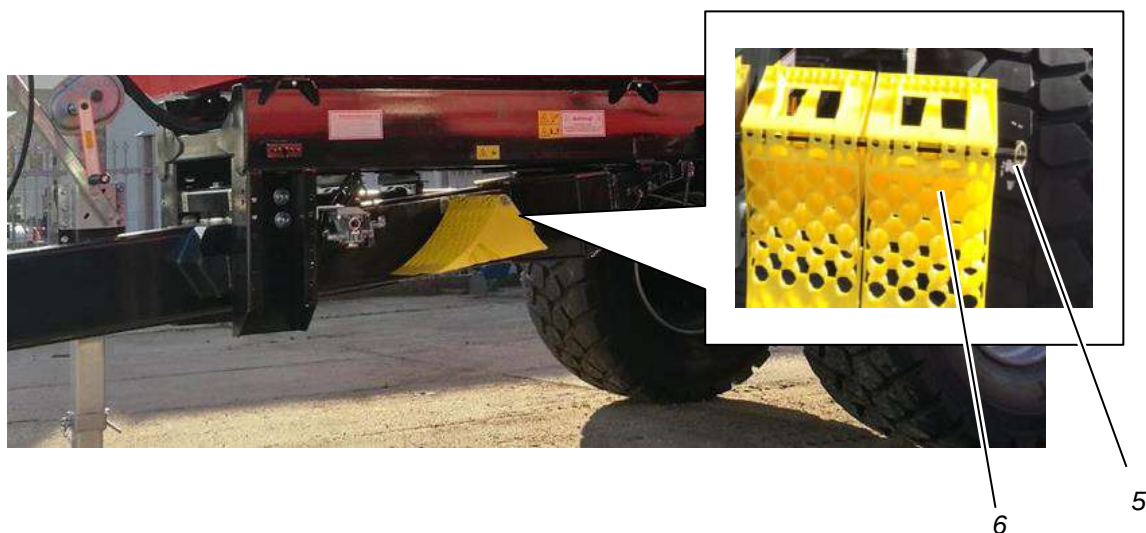
Ilustracja 26: Klin pod koło, tutaj: MUP 20 HP
