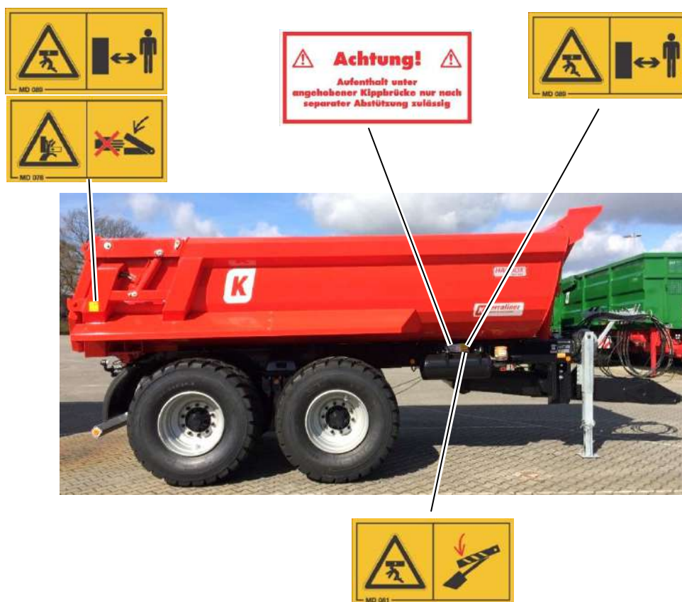
Ilustracja 5: Tabliczki ostrzegawcze i informacyjne po prawej stronie wywrotki kolebkowej
