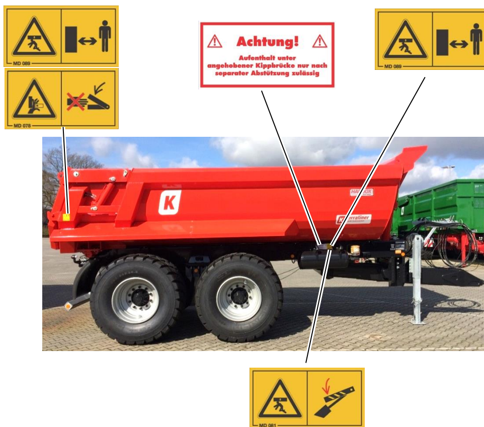
Abbildung 5: Sicherheitsschilder und Hinweisschilder an der rechten Seite des Muldenkippers
