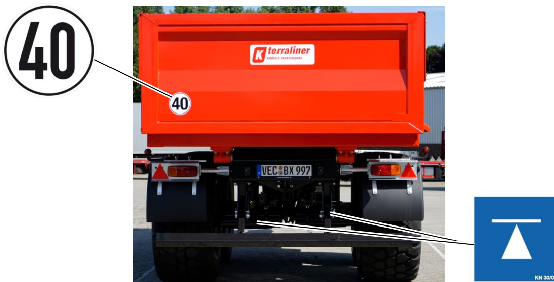
Afbeelding 7: instructieborden achterzijde chassis
