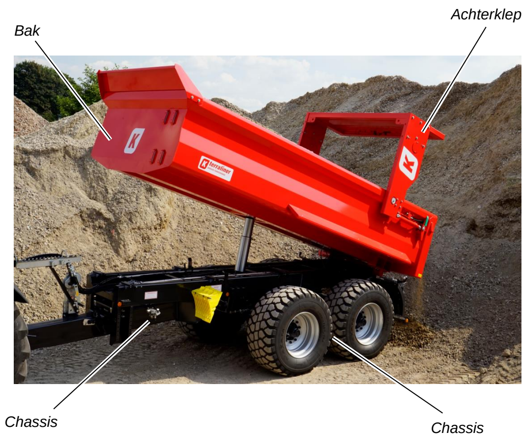
Afbeelding 11: hoofdmodules dumper, hier: MUP 20 SP
