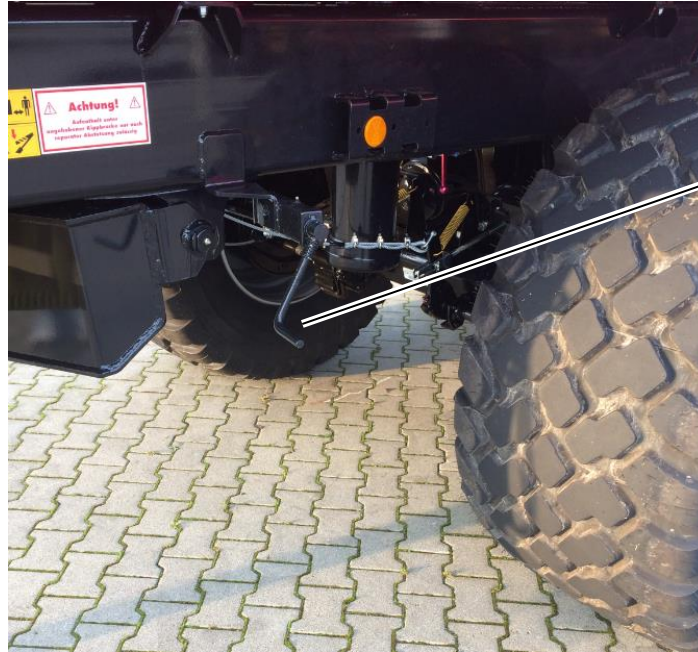
Afbeelding 25: parkeerram (slinger in verstelpositie), hier MUP 20 SP
