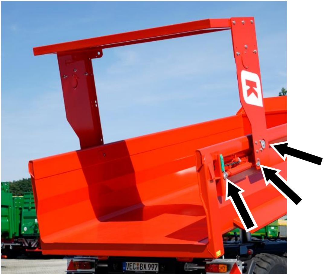
Ilustracja 39: Smarowanie klapy tylnej
