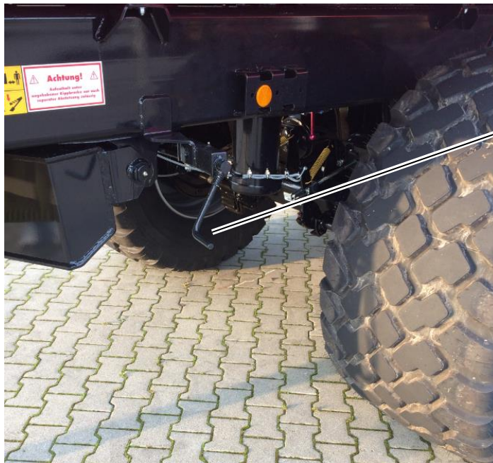
Ilustracja 25: Hamulec postojowy (korba w pozycji regulacji), tutaj: MUP 20 SP
