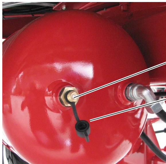
Ilustracja 43: Przyłączy kontrolne na manometr na zasobniku sprężonego powietrza
