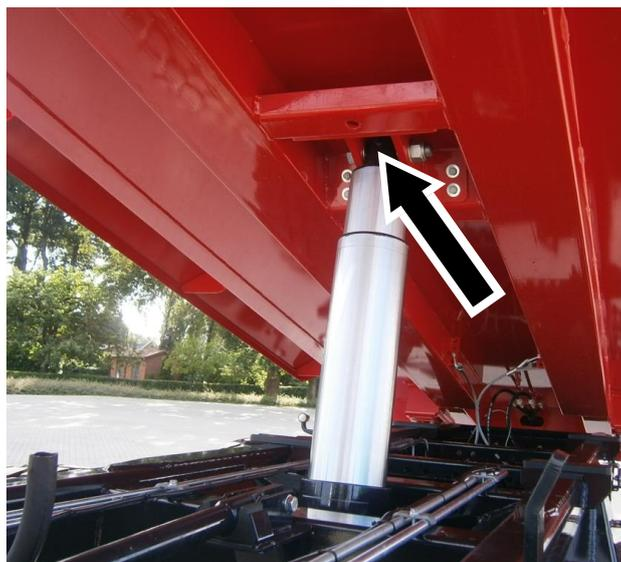
Abbildung 40: Kipplager und Kippzylinder
