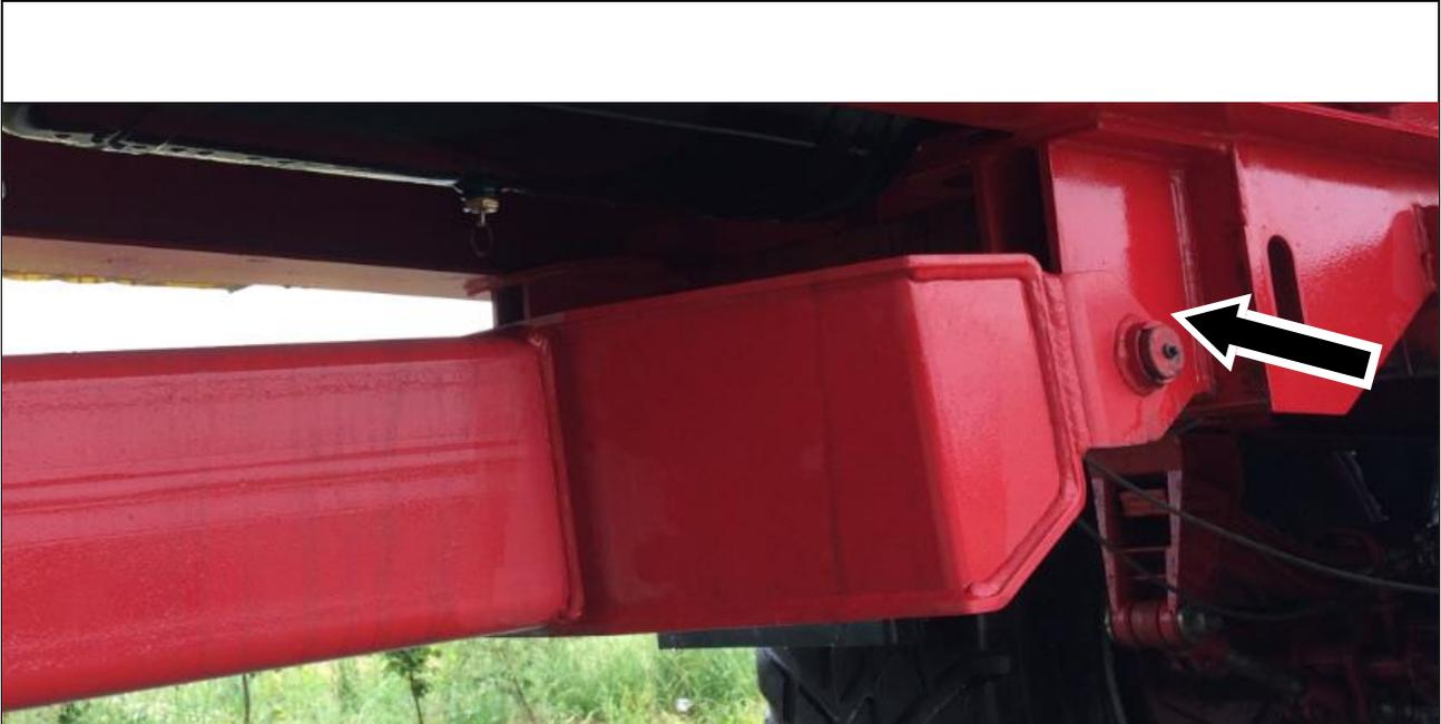
Abbildung 37: Schmiernippel an Zugeinrichtung
