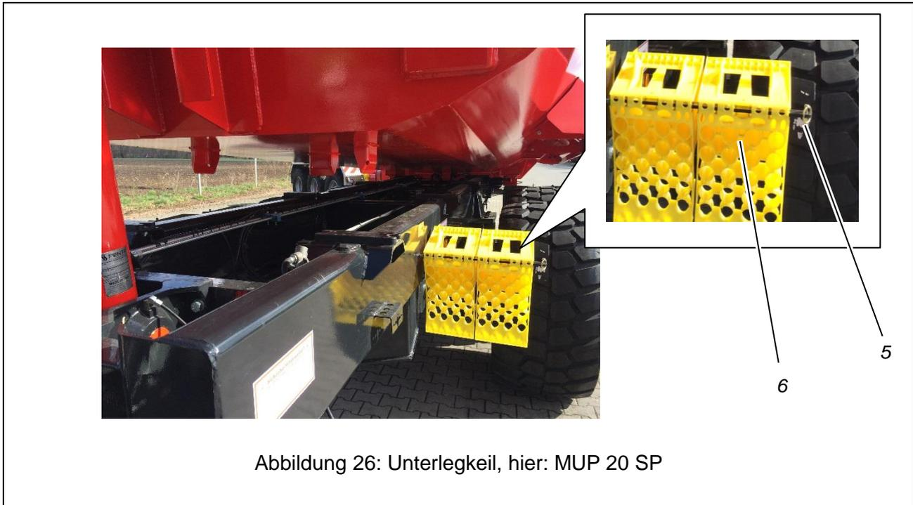
Abbildung 26: Unterlegkeil, hier: MUP 20 SP
