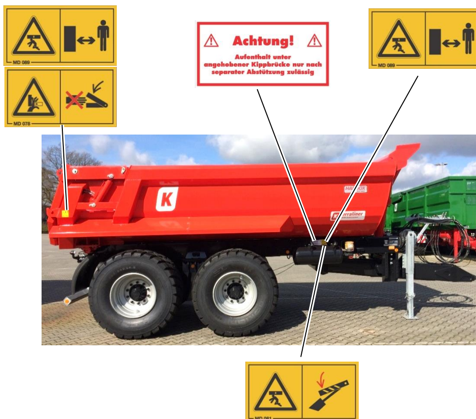
Illustration 5 : panneaux de sécurité et d'indication sur le côté droit de la benne basculante
