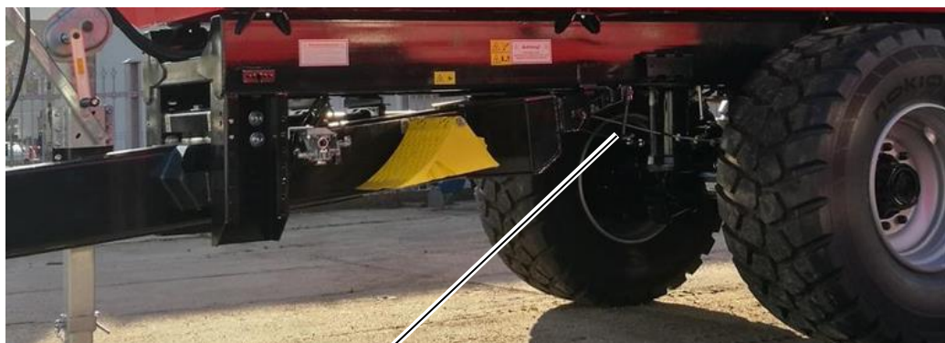
4 Illustration 25 : frein de stationnement (manivelle en position de réglage), illustré ici : MUP 20 HP
