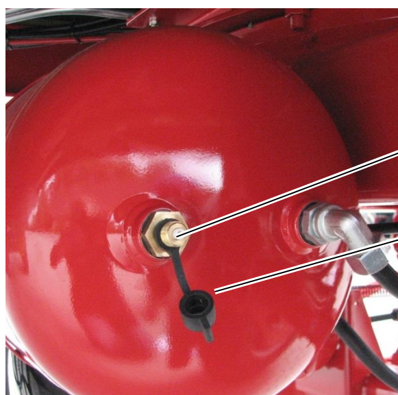
Illustration 51 : prise de pression pour manomètre sur le réservoir d'air comprimé
