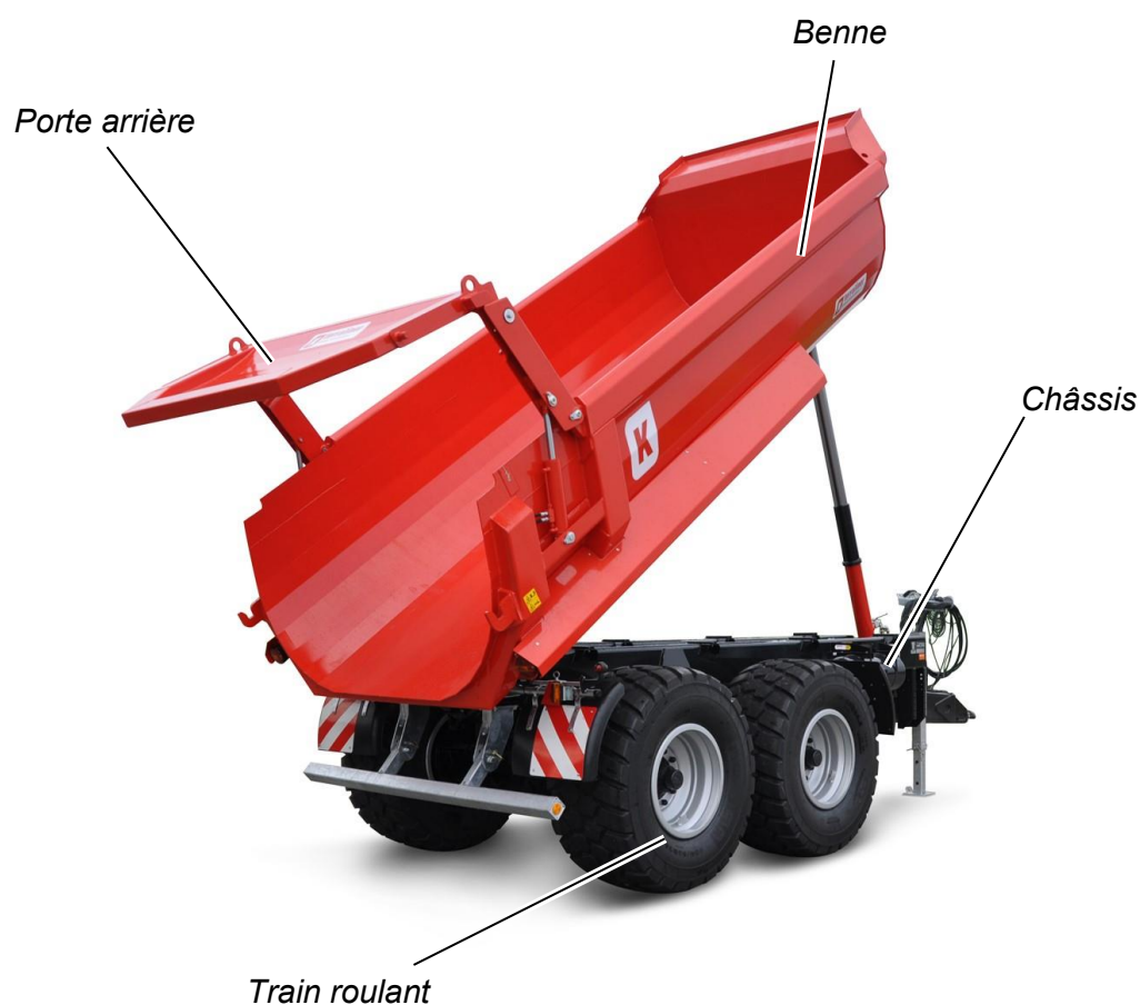
Illustration 11 : sous-ensembles principaux de la benne basculante, ici : MUP 20 HP
