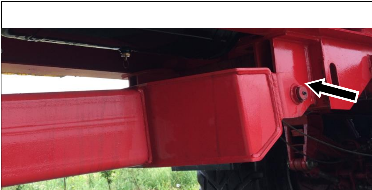
Illustration 44 : graisseur sur le dispositif de traction (gauche et droite)
