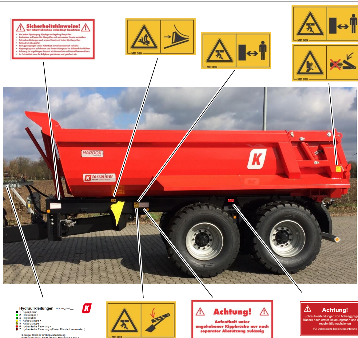
Illustration 4 : panneaux de sécurité et d'indication sur le côté de la benne basculante, ici : MUP 20 HP côté gauche
