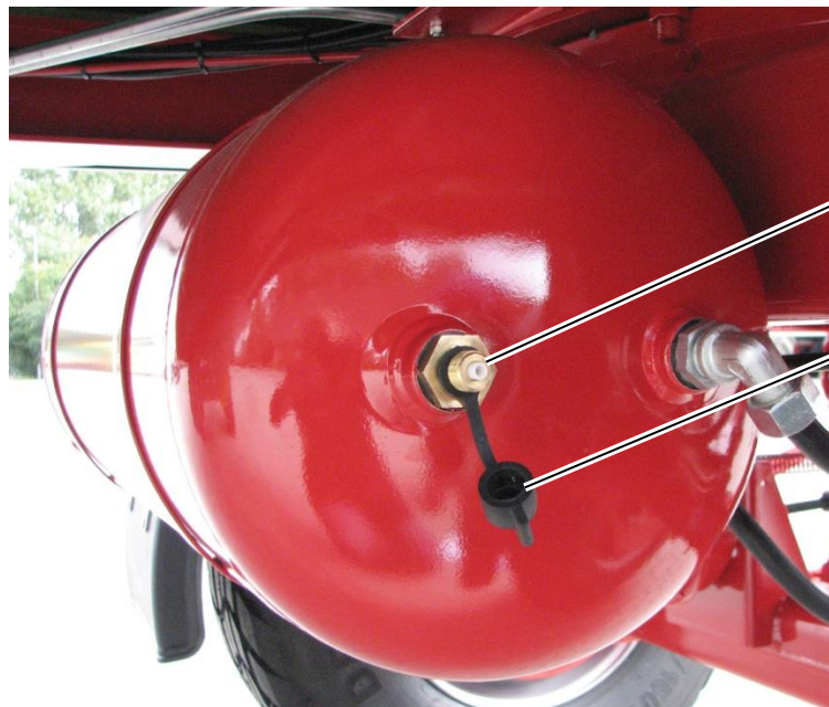
Afbeelding 53: testaansluiting voor een manometer op persluchtreservoir
