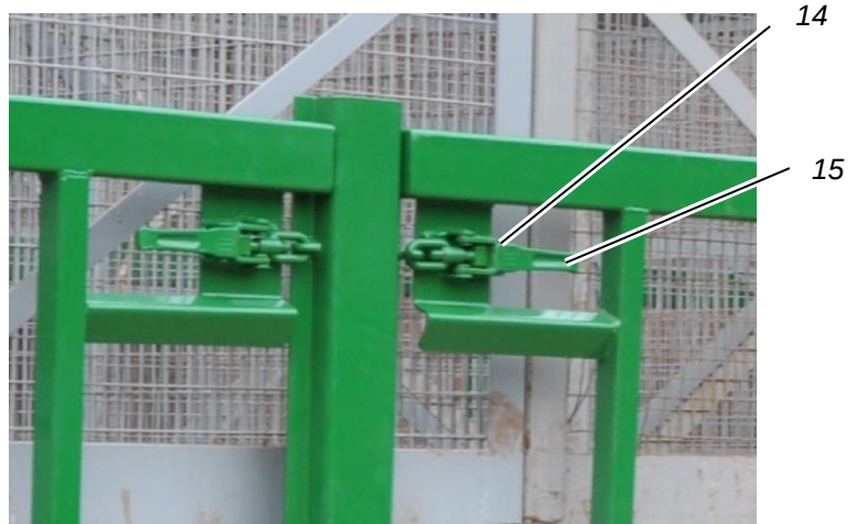
Afbeelding 29: zijwandsluiting gesloten, hier: rechts voor
