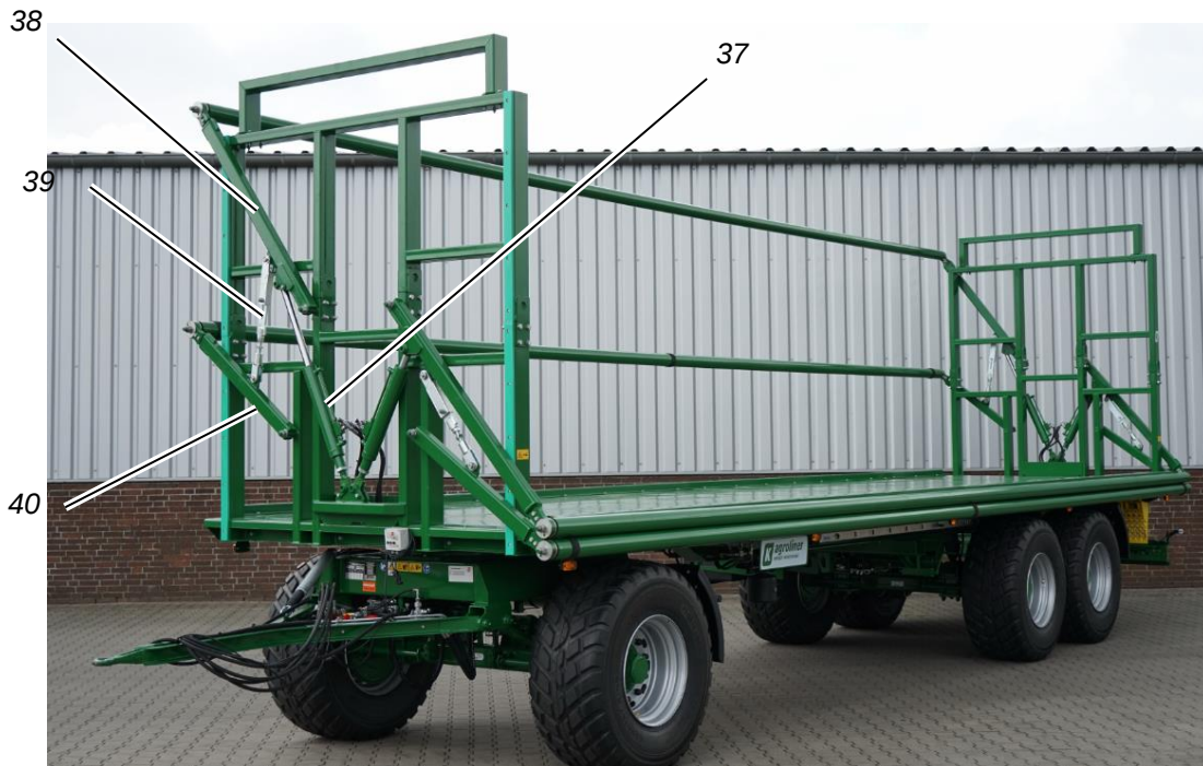
Afbeelding37: eenzijdig neergelaten zekering, hier: PWO
