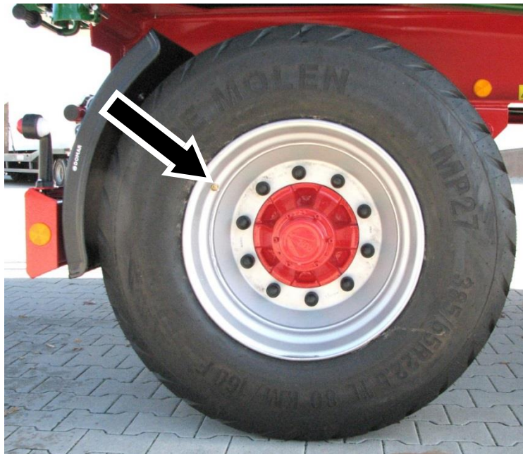
Afbeelding 42: Bandventiel, hier: PWO 18 - band rechts achter
