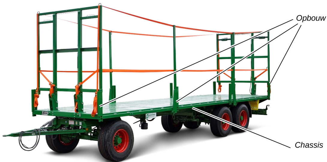
Afbeelding 10: hoofdmodules platformaanhangwagen, hier: PWO 24
