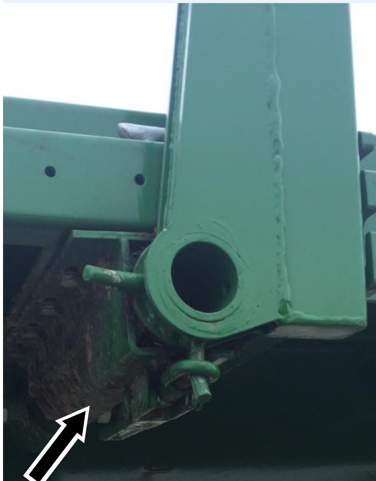
Afbeelding 51: 4 lagerbouten van de cardanring
