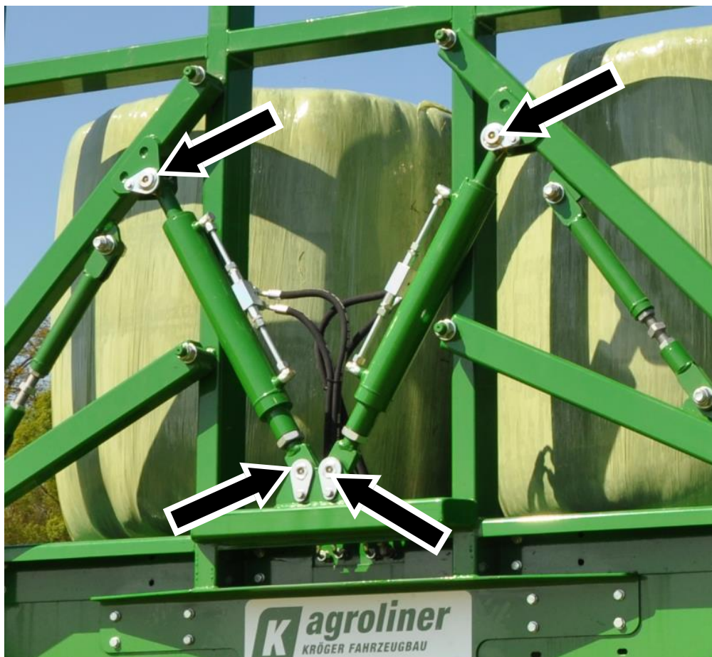
Afbeelding 49: smeernippel van de telescopische cilinderkogel
