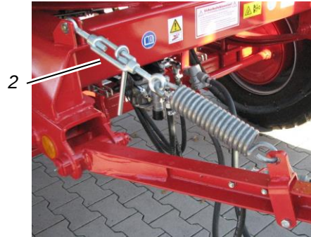
Afbeelding 24: Hoogte-instelling Trekdissel, hier: PWO 18
