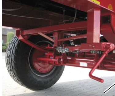
Afbeelding 25: parkeerrem (slinger in verstelpositie), hier: PWO 18
