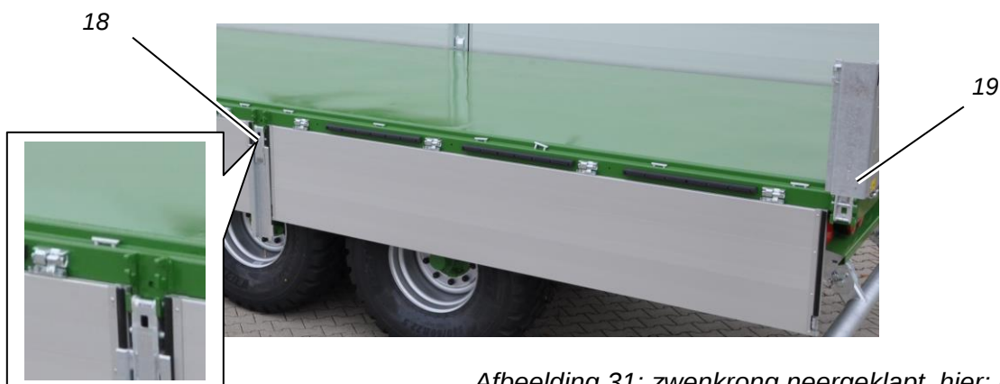
Afbeelding 31: zwenkrong neergeklapt, hier: links voor
