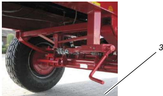
Ilustracja 25: Hamulec postojowy (korba w pozycji regulacji), tutaj: PWO 18
