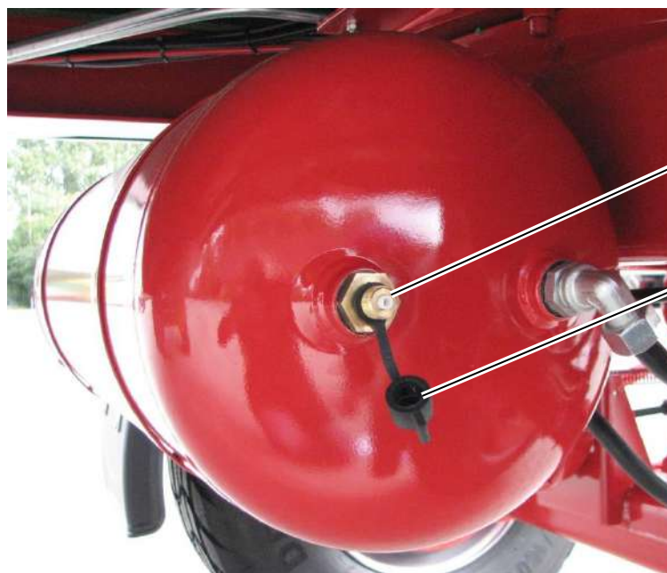
Ilustracja 53: Przyłączy kontrolne na manometr na zasobniku sprężonego powietrza
