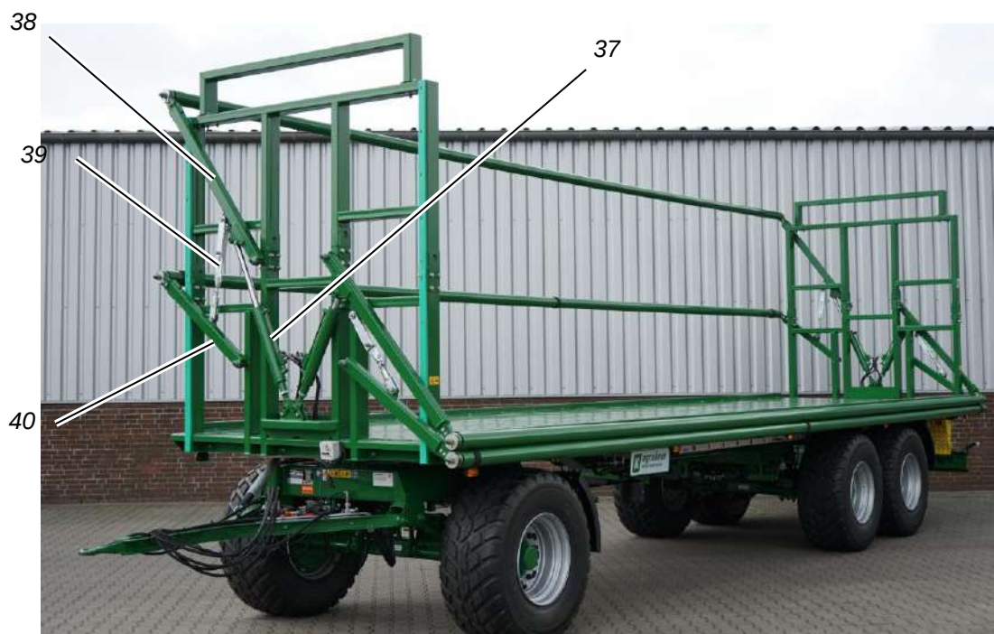
Ilustracja 37: Opuszczone z jednej strony zabezpieczenie, tutaj: PWO
