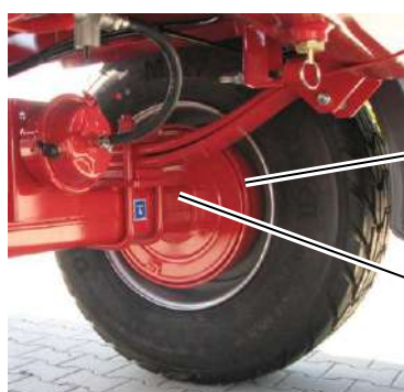
Ilustracja 39: Bęben hamulcowy i piasta koła, tutaj: PWO 18, opona przednia prawa
