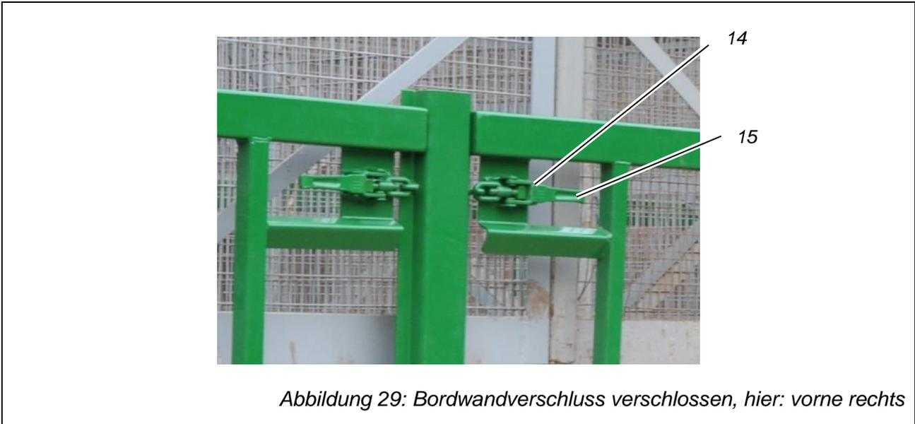
Abbildung 29: Bordwandverschluss verschlossen, hier: vorne rechts
