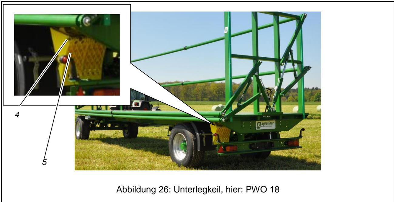
Abbildung 26: Unterlegkeil, hier: PWO 18
