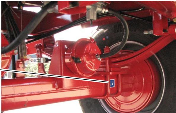
Abbildung 4: Kennzeichnung der Ansetzpunkte für Wagenheber, hier: vorne rechts
