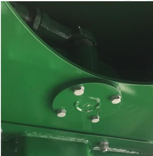
*Abbildung 50: Schmiernippel der Teleskopzylinderkugel*
