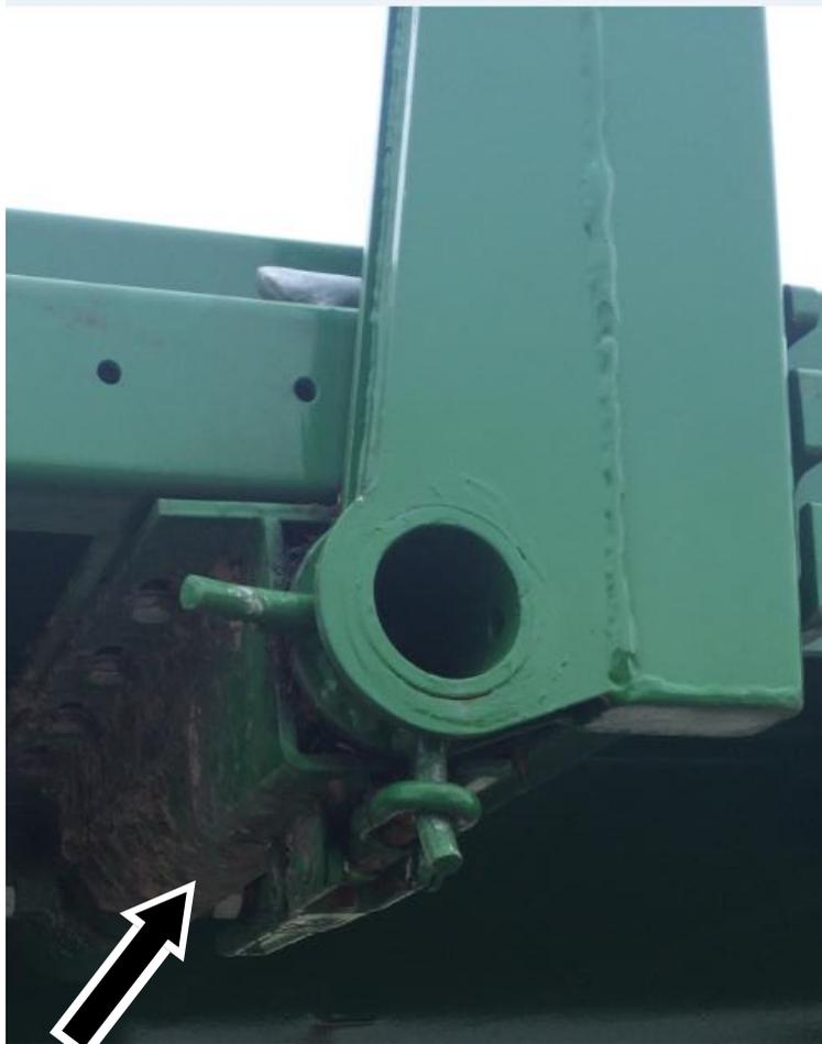
Abbildung 51: 4 Lagerbolzen des Kardanrings
