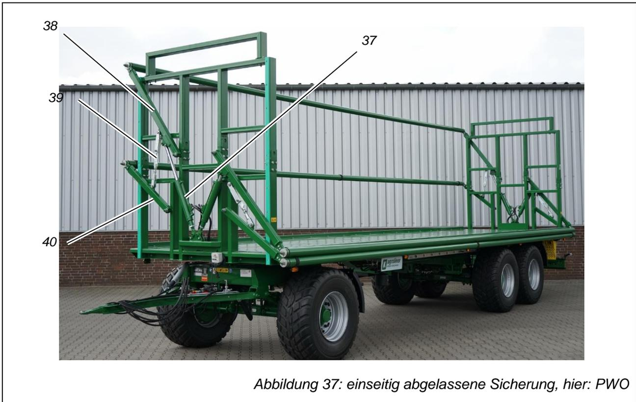
Abbildung 37: einseitig abgelassene Sicherung, hier: PWO
