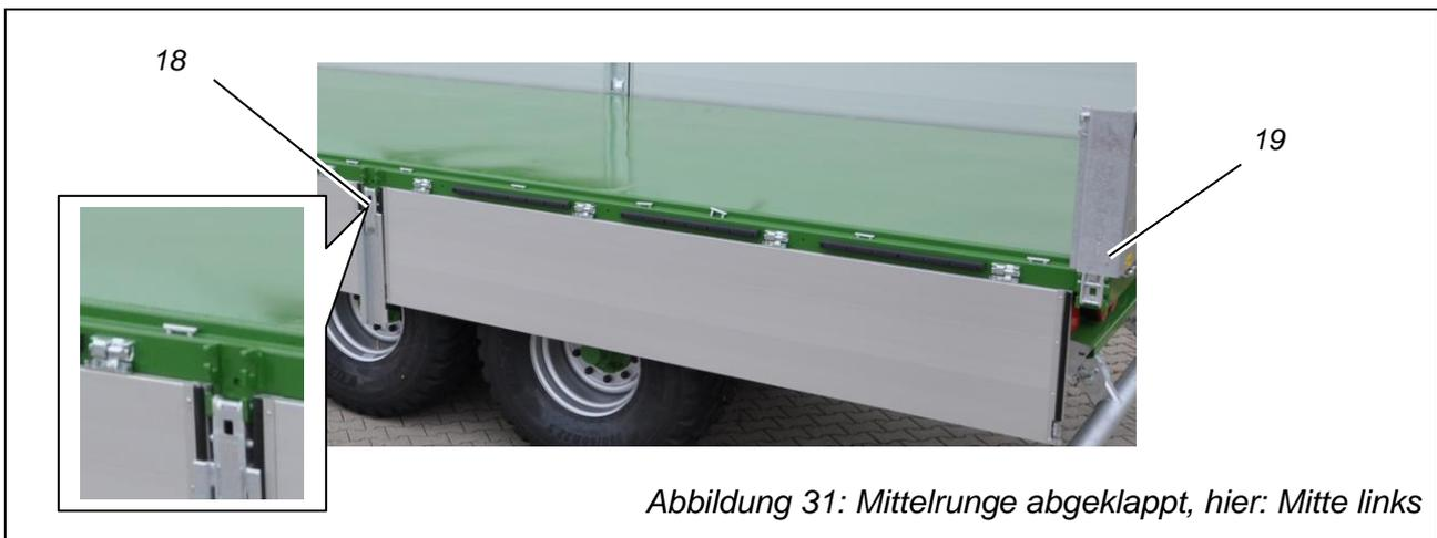
Abbildung 31: Mittelrunge abgeklappt, hier: Mitte links
