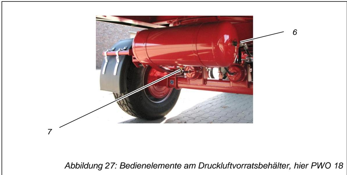
Abbildung 27: Bedienelemente am Druckluftvorratsbehälter, hier PWO 18
