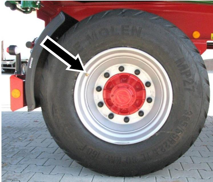
Abbildung 42: Reifenventil, hier: PWO 18 – Reifen hinten rechts
