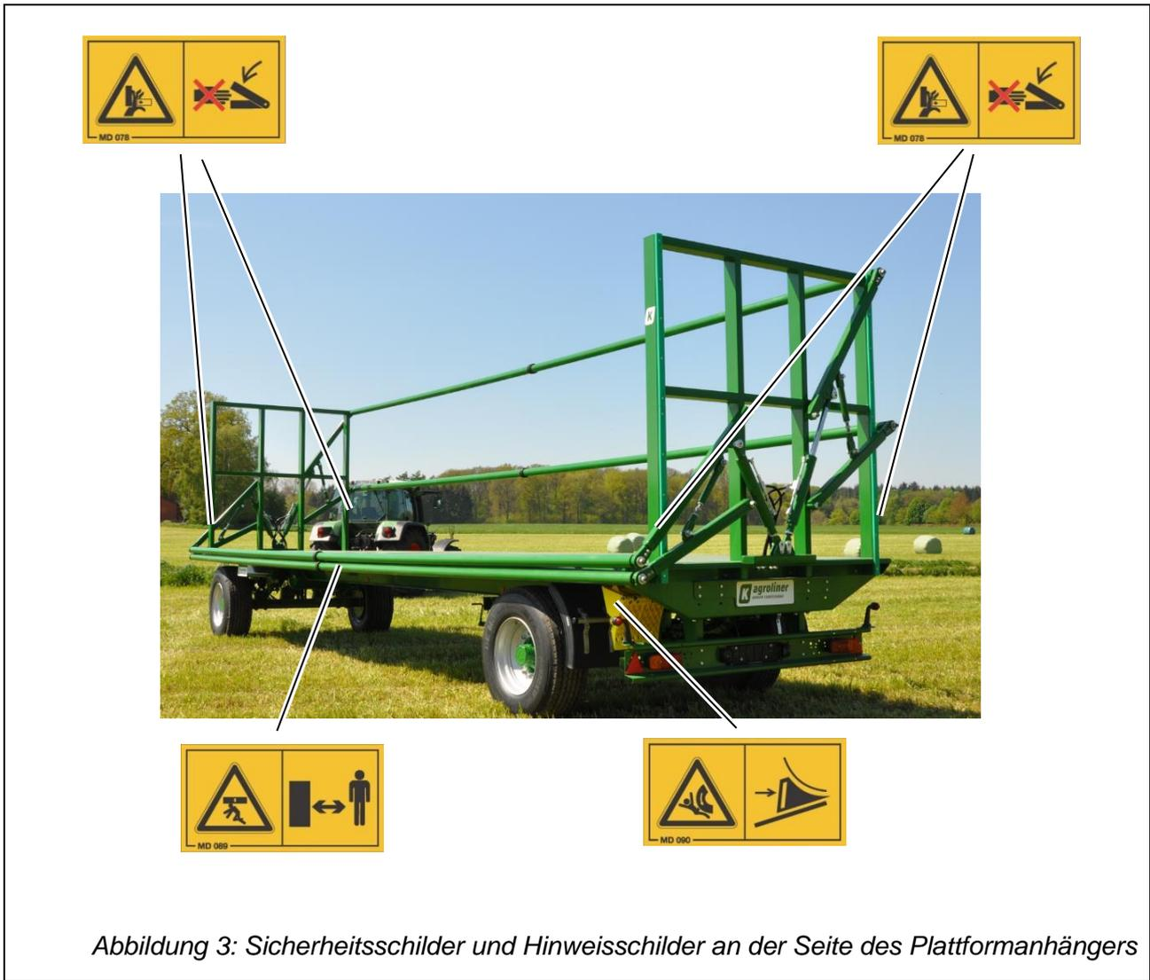
Abbildung 3: Sicherheits- und Hinweisschilder an der Seite des Plattformanhängers
