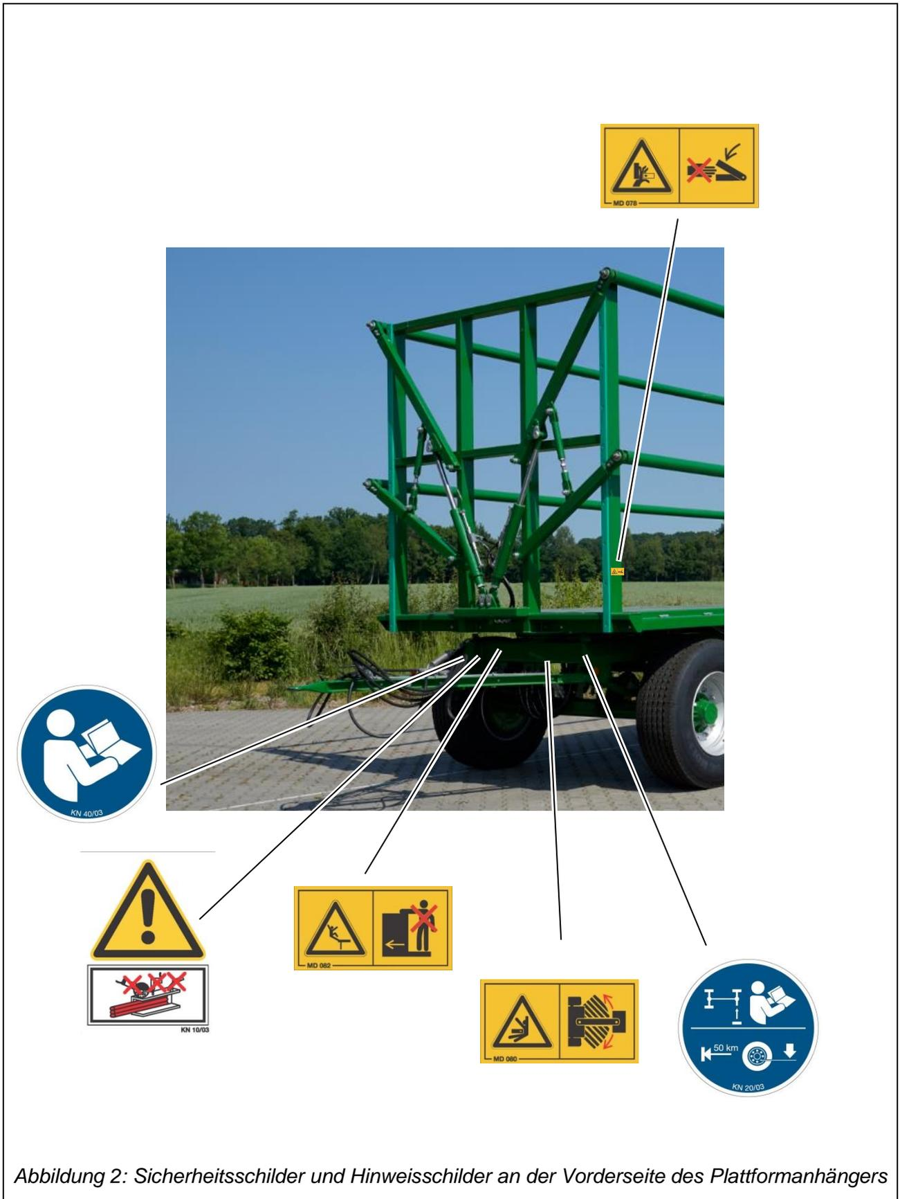
Abbildung 2: Sicherheitsschilder und Hinweisschilder an der Vorderseite des Plattformanhängers
