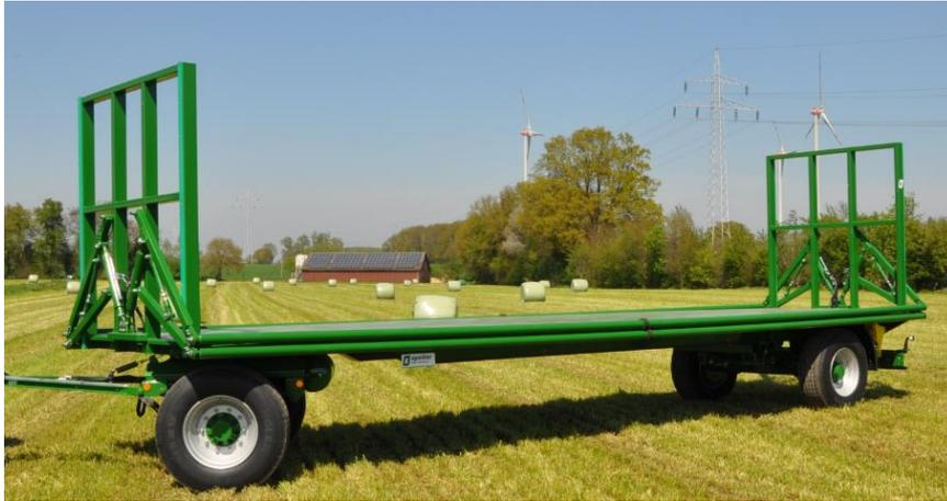
Abbildung 6: Drehschemelanhänger PWO 18
