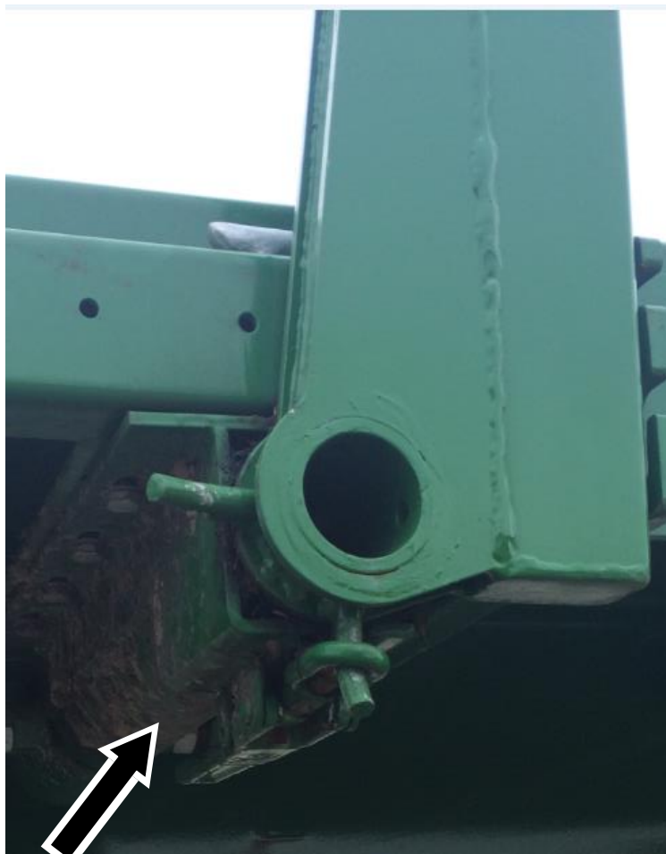
51. ábra: 4 Kardángyűrű csapágycsapjai
