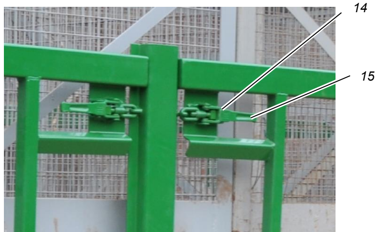
29. ábra: Bukóoldalzár zárva, itt: jobbra elől
