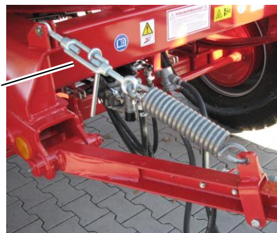
24. ábra: Magasságbeállítás Vonórúd, itt: PWO 18
