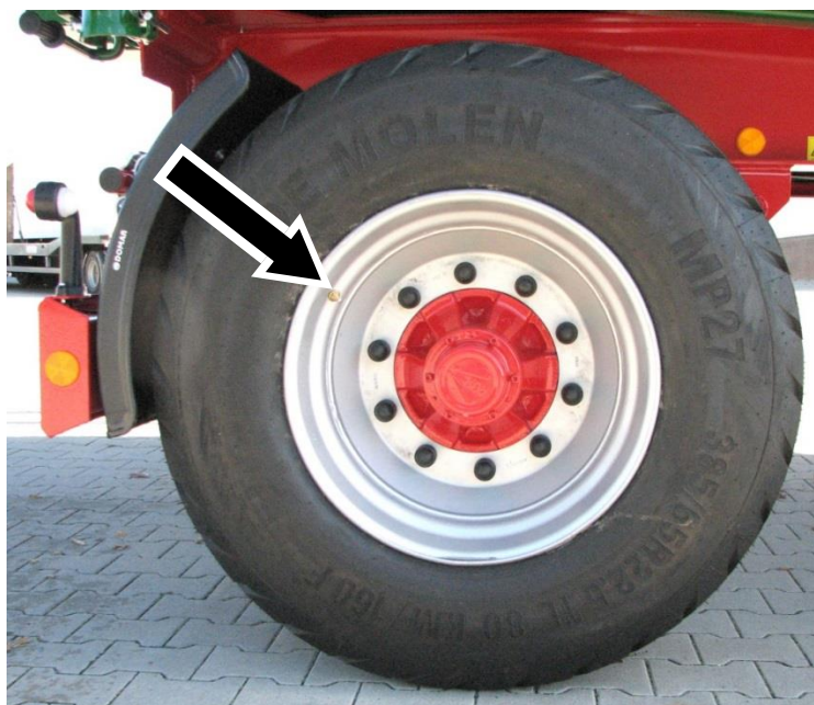
42. ábra: Gumiabroncs-szelep, itt: PWO 18 – jobb hátsó gumiabroncs
