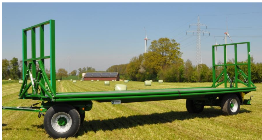
6. ábra: Forgózsámolyos pótkocsi PWO 18
