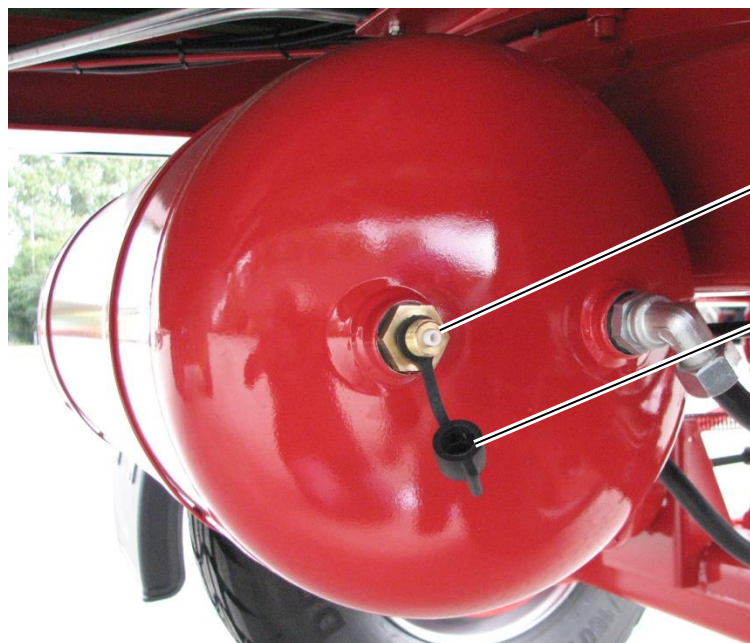
53. ábra: Tesztcsatlakozó a sűrítettlevegő-tartály nyomásmérőjéhez
