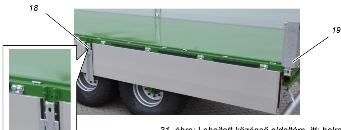
31. ábra: Lehajtott középső oldaltám, itt: balra középen
