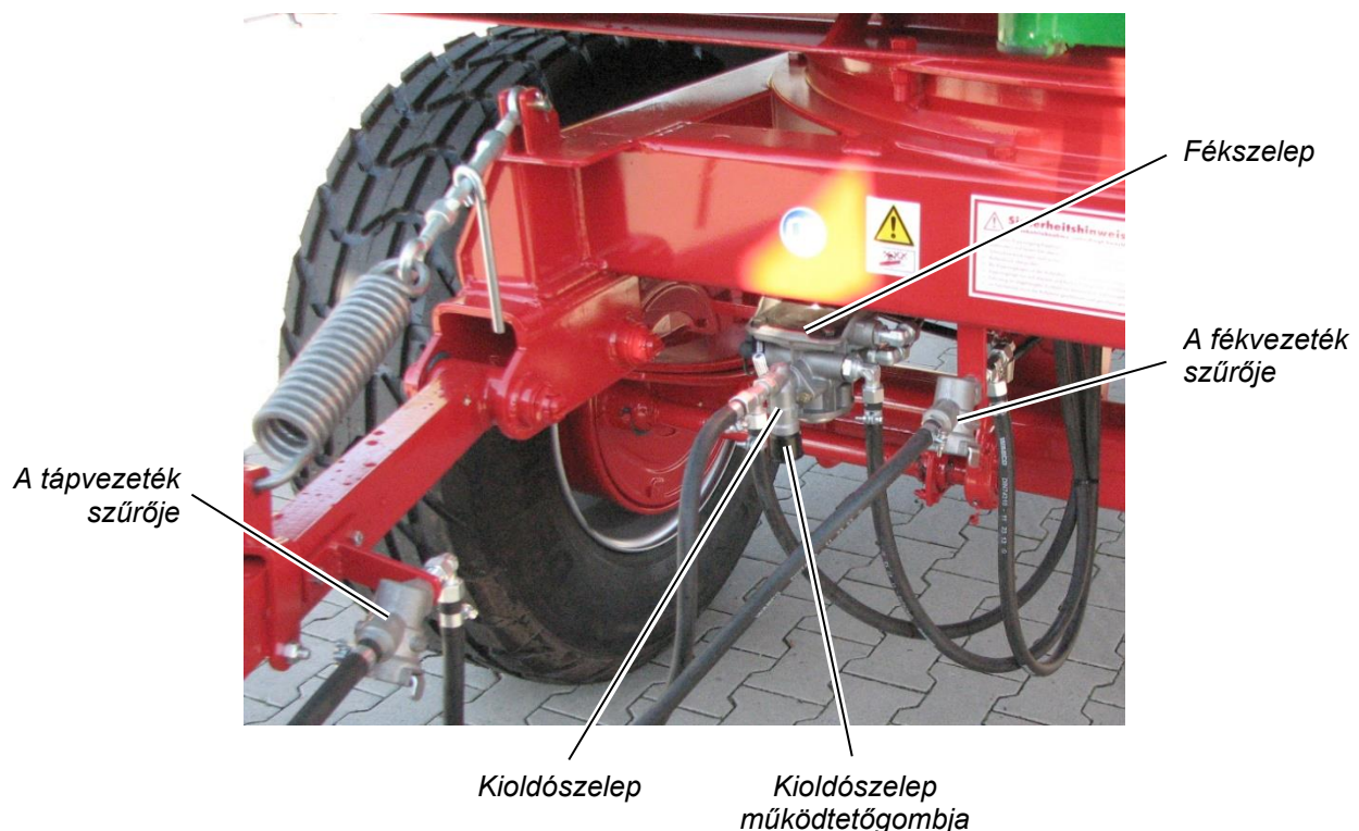
13. ábra: Üzemi fék szelepei és szűrői, itt: PWO 18
