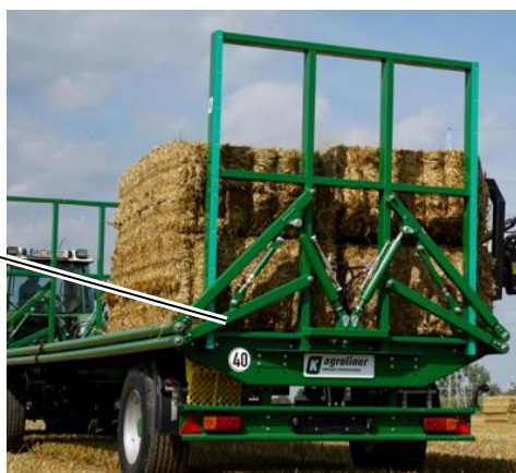
5. ábra: Tájékoztató jelzések az alváz hátoldalán
