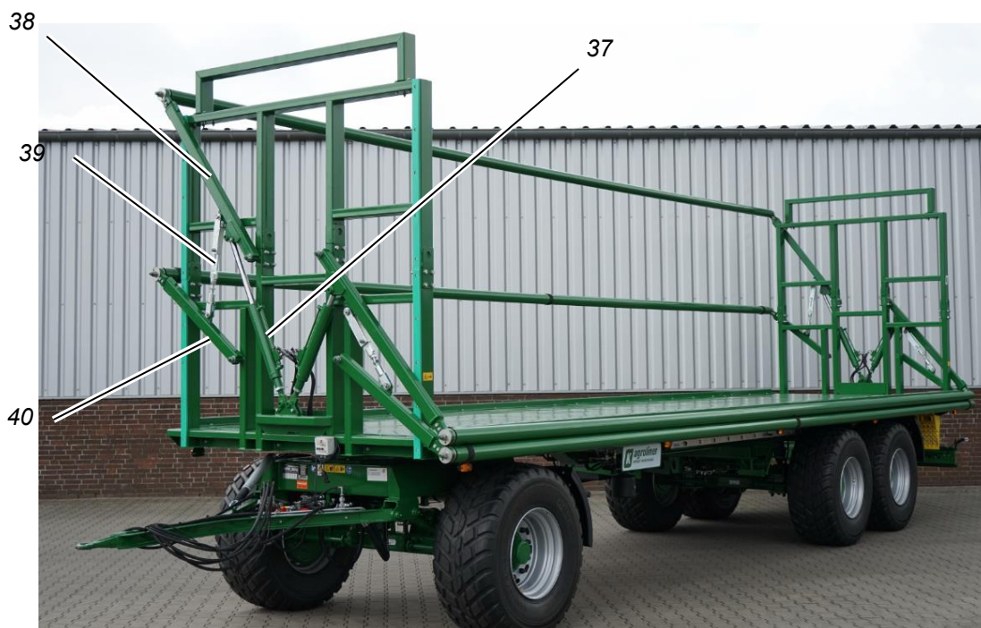
37. ábra: egyoldalúan leeresztett rögzítő, itt: PWO
