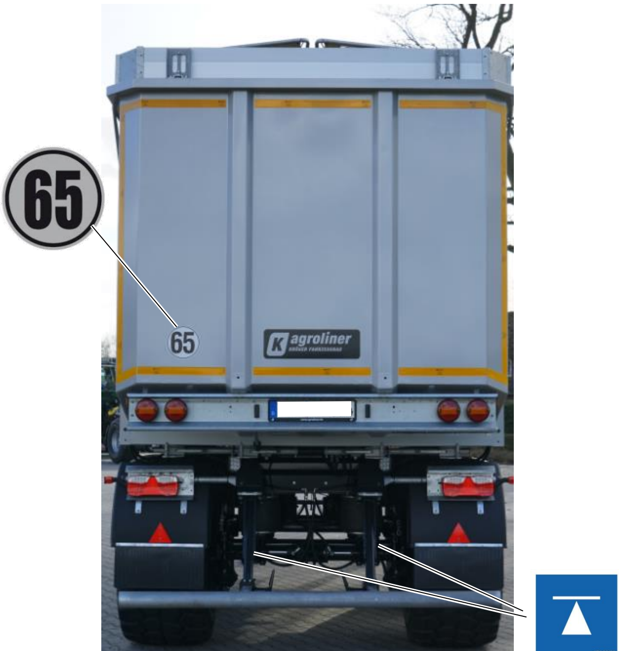
Abbildung 4: Sicherheitsschilder hinten am Auflieger
