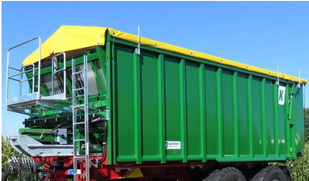
Abbildung 33: Rollplane korrekt verschlossen
