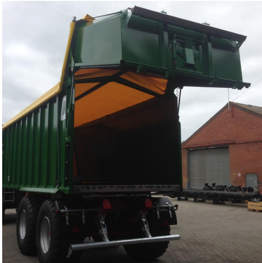
Abbildung 34: Rollplane geschlossen gesichert
