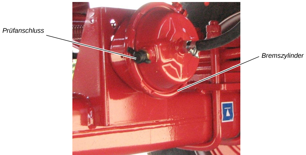
Abbildung 44: Prüfanschluss für Bremszylinderdruck
