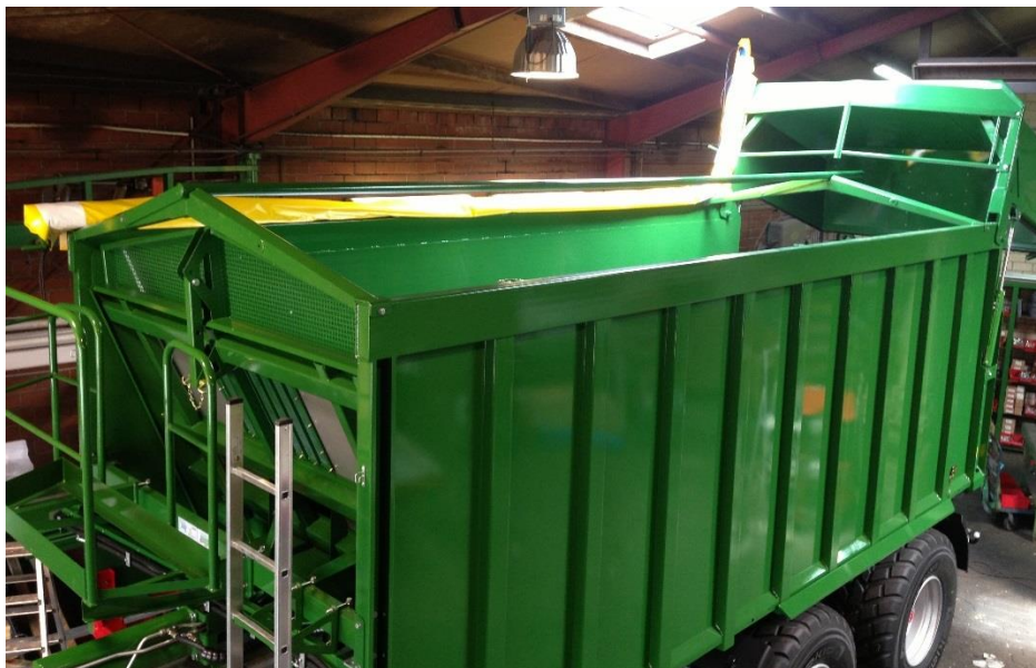
Obrázek 41: Rolovací plachta zajištěná v otevřeném stavu
