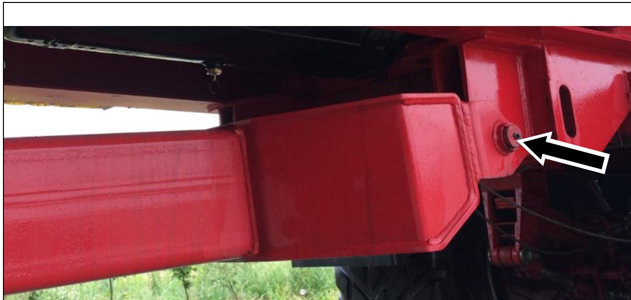
Obrázek 47: Maznice na tažném zařízení (vlevo a vpravo)
