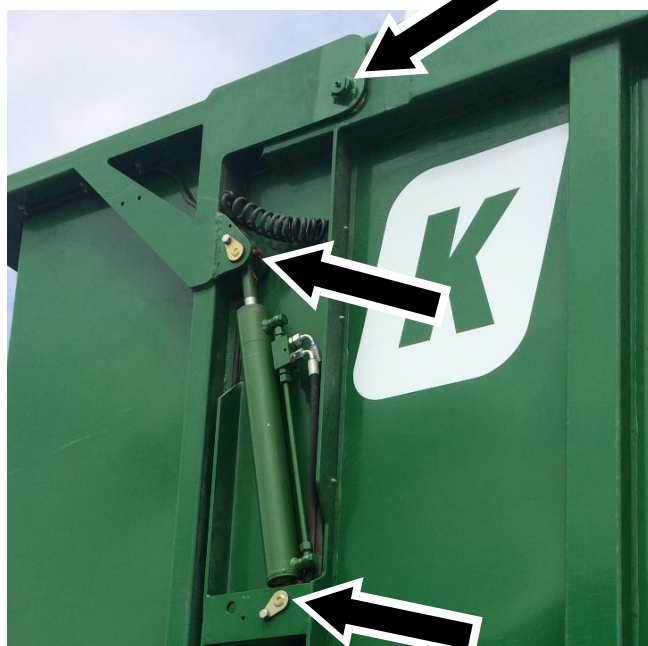
Obrázek 49: Mazání zadních výklopných dveří
