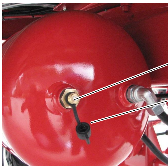
Obrázek 54: Zkušební připojení manometru na zásobníku stlačeného vzduchu
