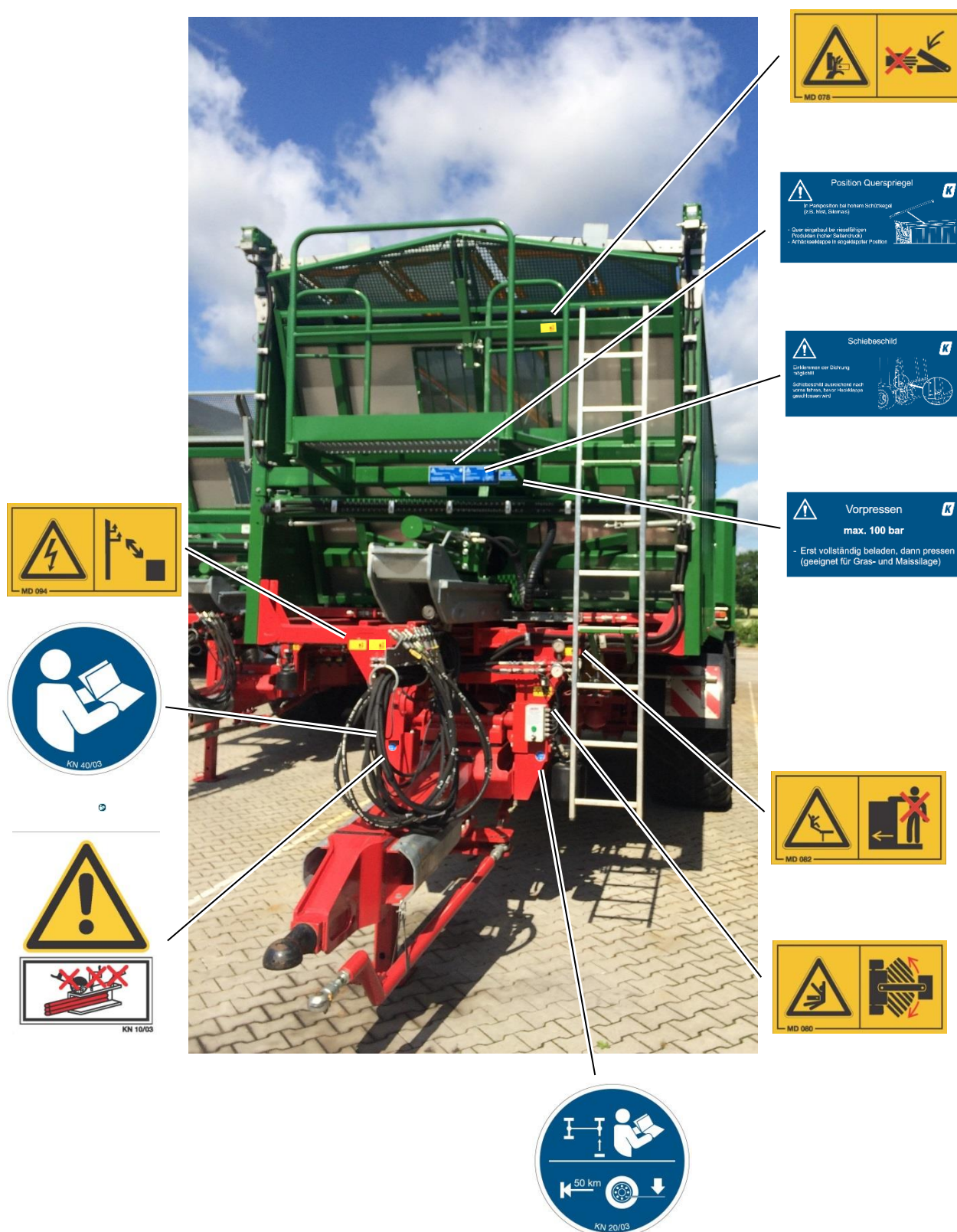
Obrázek 2: Bezpečnostní značky a informační značky na přední straně výsuvného přívěsu
