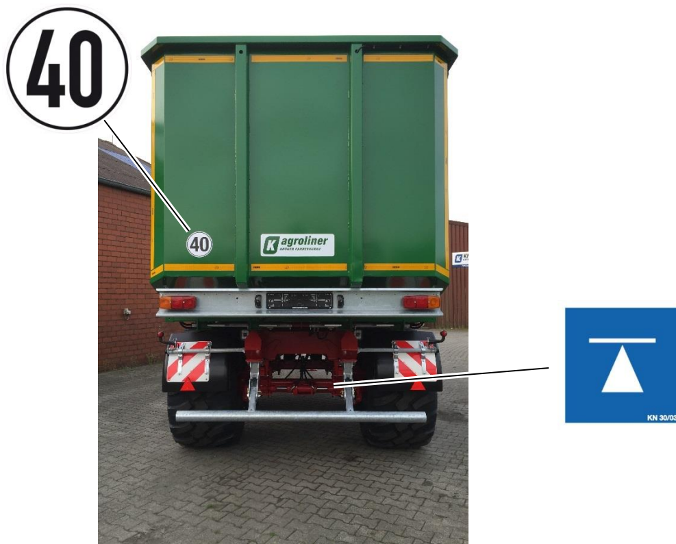
Illustration 5 : Panneaux d'indication à l'arrière du châssis
