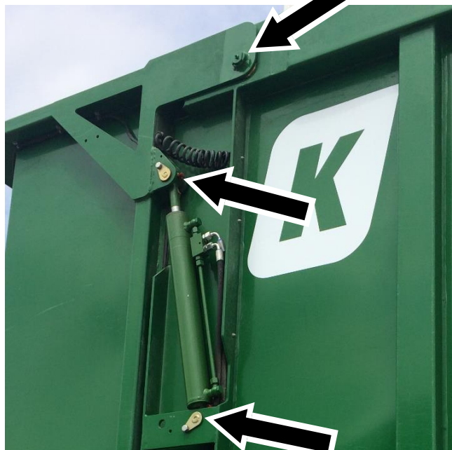
Illustration 49 : Lubrification de la porte arrière
