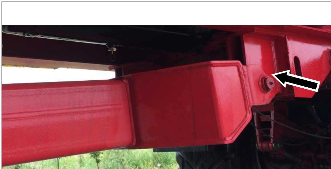
Illustration 47 : Graisseur sur le dispositif de traction (gauche et droite)
