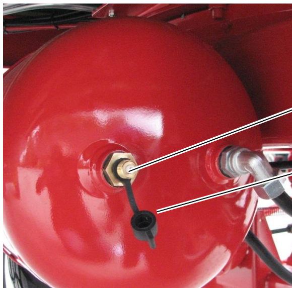
54. ábra: Tesztcsatlakozó a sűrítettlevegő-tartály nyomásmérőjéhez
