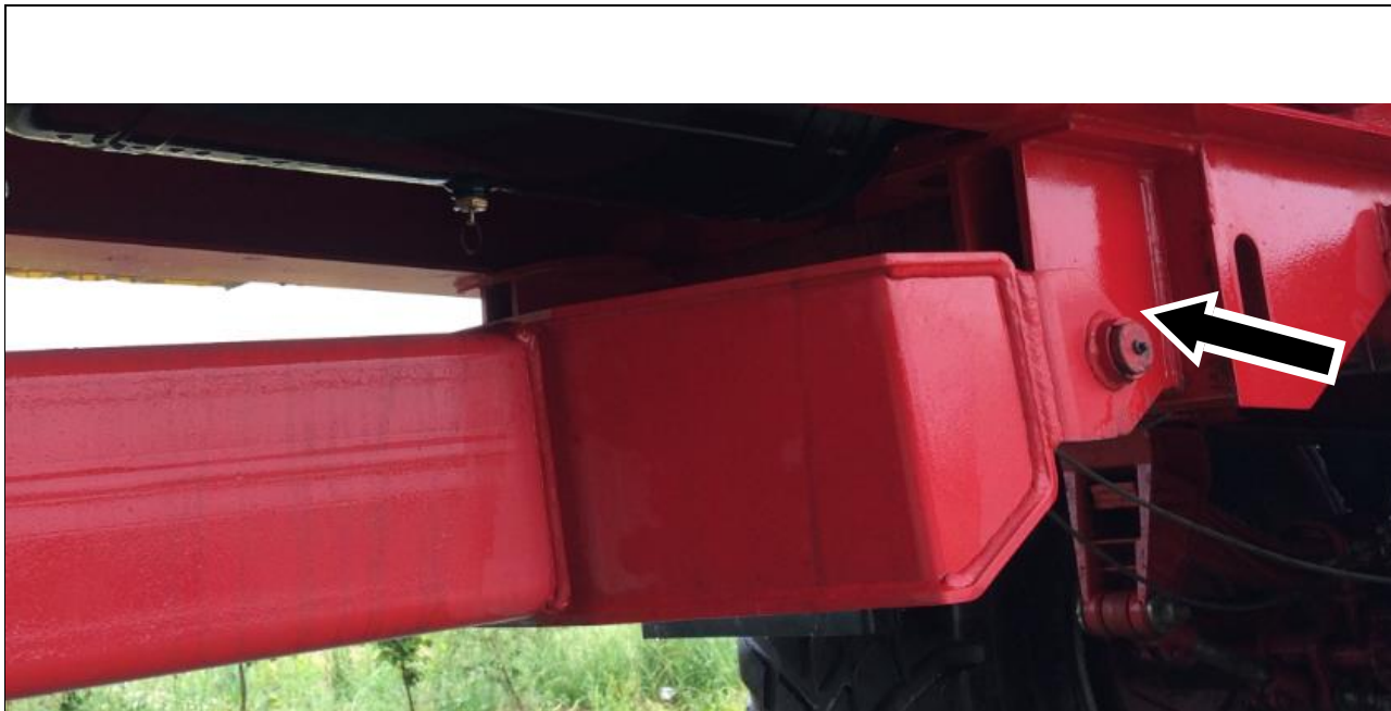
Ilustracja 48: Gniazdo smarowe na zaczepie (strona lewa identyczna z prawą)
