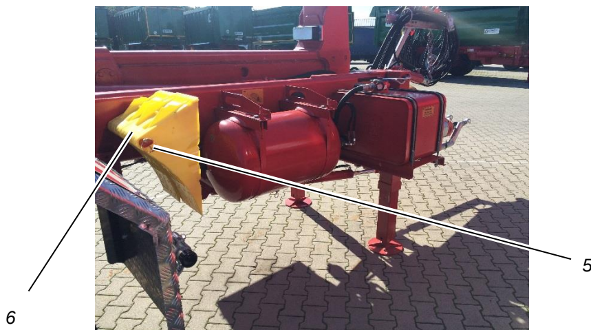
Obrázek 24: Klín pro zajištění kola, zde: THL 20 a
