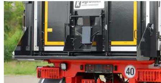
Abnehmbare **Kippbrückenverlängerung hinten** über die gesamte Fahrzeugbreite.
