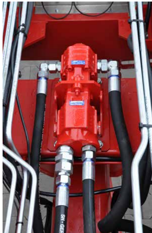
Hydraulische pomp aangedreven door een oliemotor.
