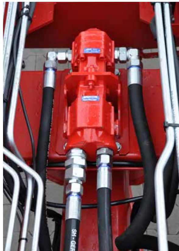
Pompa hydrauliczna napędzana przez silnik olejowy.
