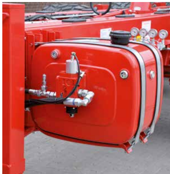
Zbiornik hydrauliczny (własne zasilanie olejem)
