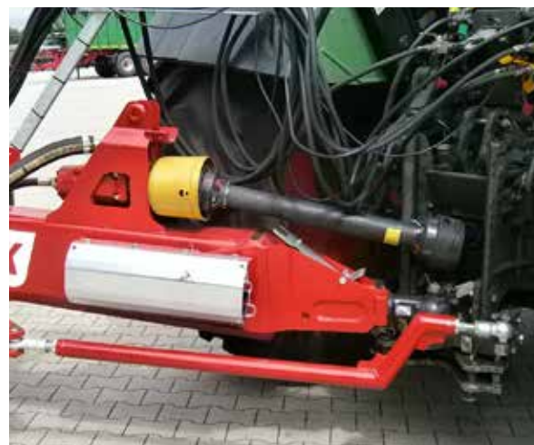
Pompa hydrauliczna napędzana przez wał odbioru mocy.
