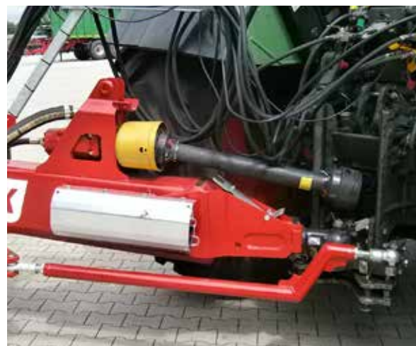
A TLT-tengelyen keresztül hajtott hidraulikaszivattyú.
