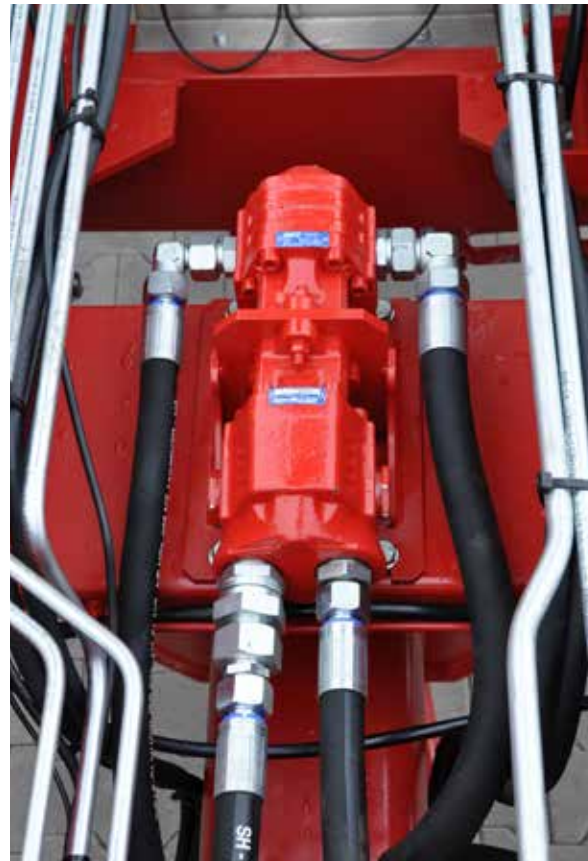
Olajmotorral hajtott hidraulikaszivattyú.
