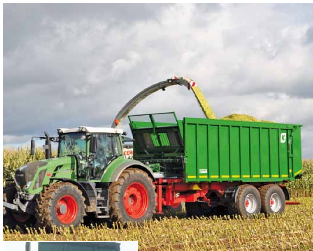
Die Volumenheckklappe, siehe großes Bild links, fasst zusätzlich rund 4 m 3 . Damit lässt sich das Ladevolumen bei Häckselgut spürbar erhöhen.
